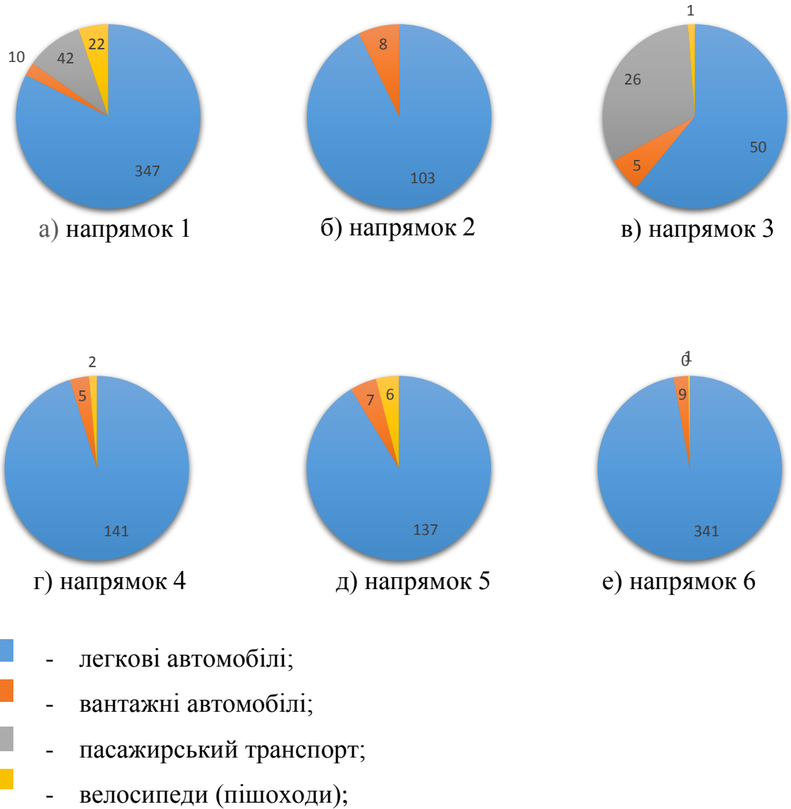
Рис.1.6 Склад транспортних потоків на перехресті вулиць Замкова – Руська з 8:00 до 9:00.
