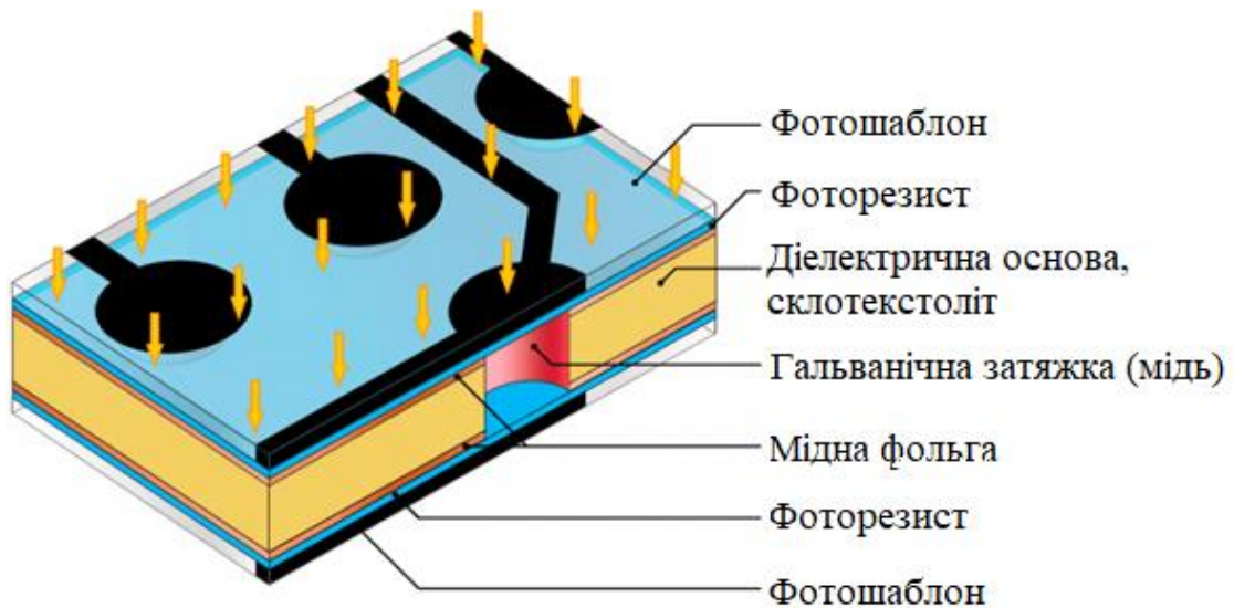
Рисунок 1.31 – Вигляд поєднання заготовки з негативними фотошаблонами
