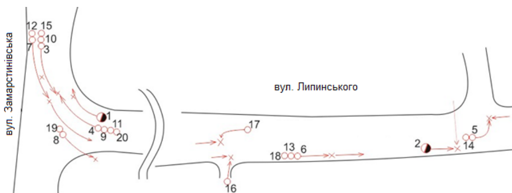
Рисунок 1.6 - Вогнищевий аналізування виникнення ДТП на перехресті вул. Липинського - вул. Замарстинівська і перегону вул. Липинського
