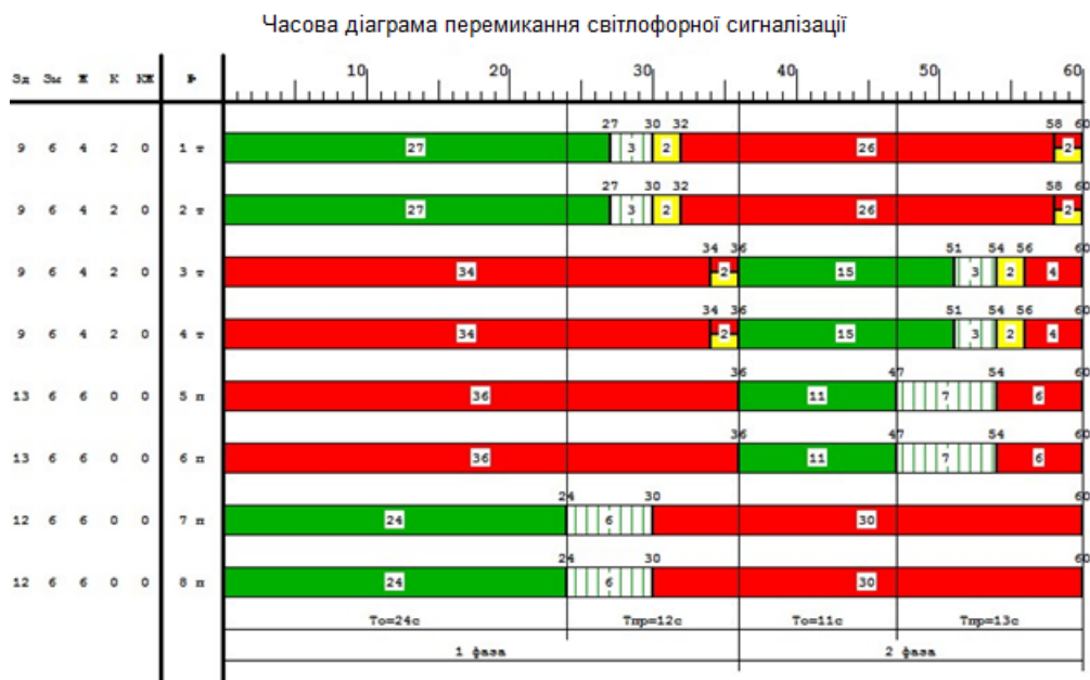
Рисунок 2.7 - Пропонована діаграма перемикання світлофорної сигналізації
