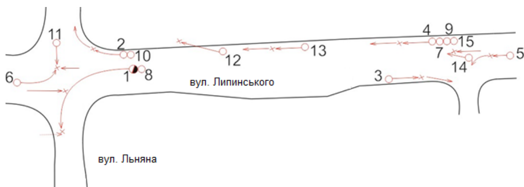
Рисунок 1.7 - Вогнищевий аналізування виникнення ДТП на перехресті вул. Липинського - вул. Льняна і перегону вул. Липинського
