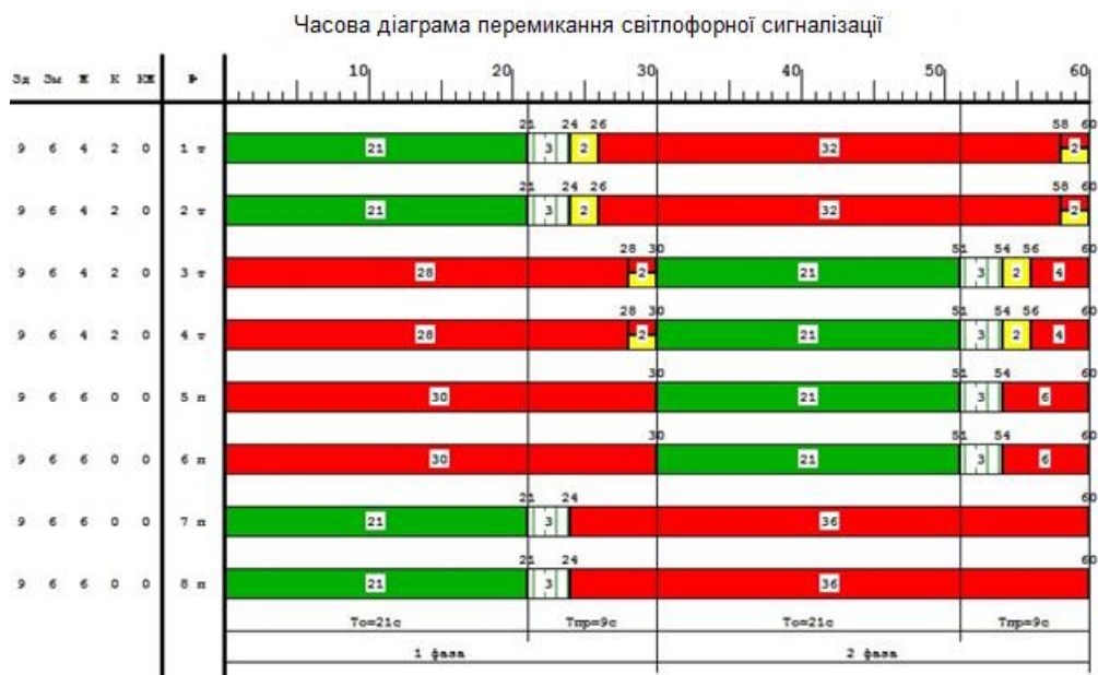
Рисунок 2.6 - Існуюча діаграма перемикання світлофорної сигналізації
