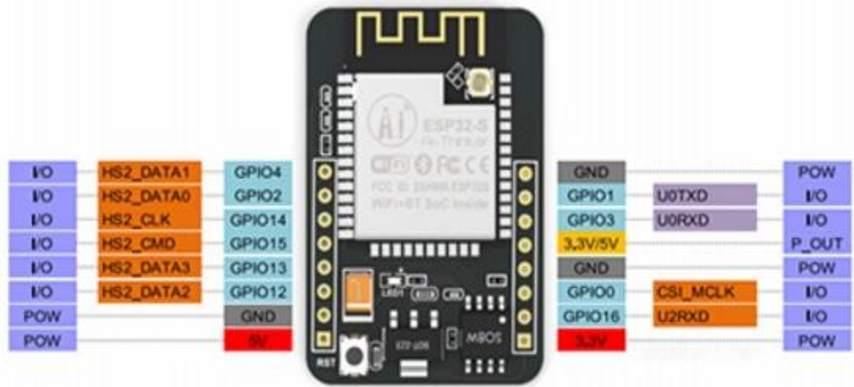
Рисунок 2.5 – Виводи ESP32-CAM
