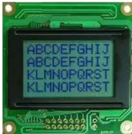
Рисунок 2.8 - Зовнішній вигляд LCD-дисплея BC1004A
