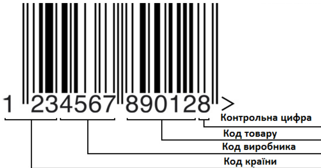
Рисунок 1.1 – Розшифрування 1D штрих-коду стандарту EAN-13
