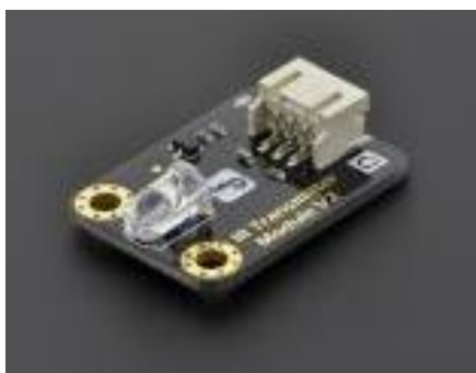
Рисунок 2.8 – ІЧ-передавач для Arduino від DFRobot
