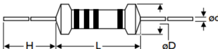
Рисунок 2.5 - Зовнішній вигляд та розміри резистора CFR-25 – R1-R9, R11-R19, R21, R23.
