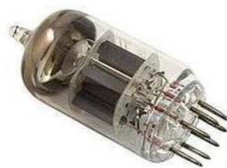
Рисунок 2.12 -Зовнішній вигляд подвійного тріода
