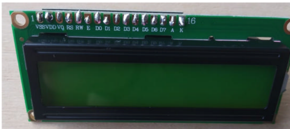
Рисунок 3.3 – Дисплей 1602A після пайки
