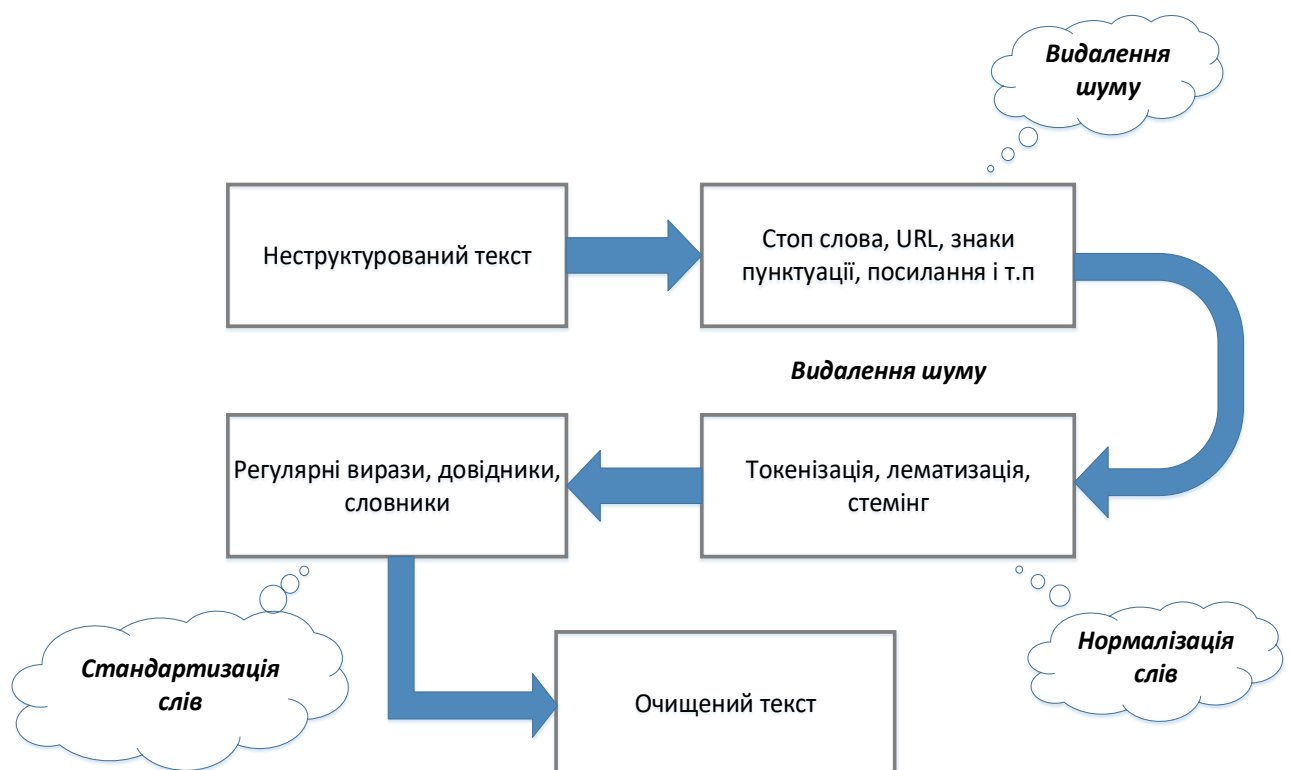
Рисунок 2.2 – Схема препроцесингу текстових даних
