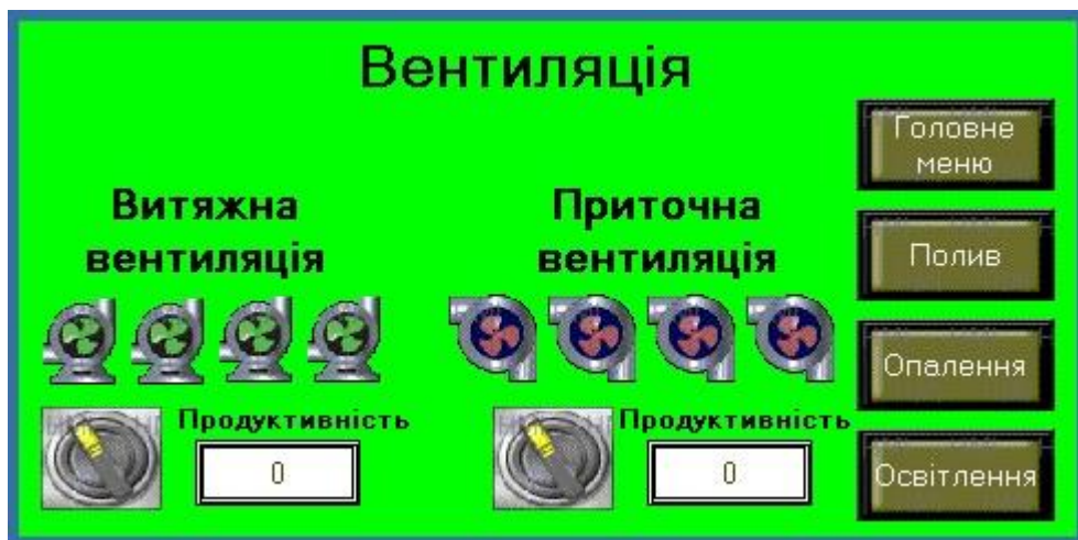
Рис. 3.13 – Екран керування пристроями вентиляції
