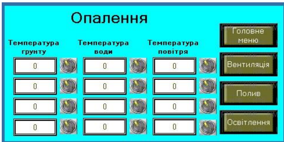
Рис. 3.10 – Екран керування системою опалення теплиці
