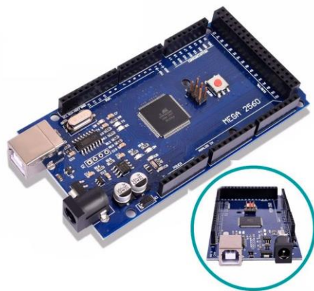
Рисунок 2.4 – Мікроконтролерний модуль Arduino Mega 2560
