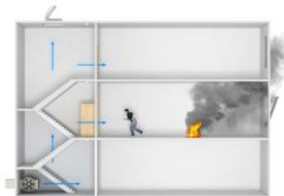
Рисунок 1.9 - Витіснення димових газів (наприклад, через системи перепаду тиску).
