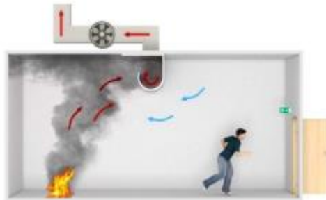
Рисунок 1.10 - Принцип вихрового димовидалення.
