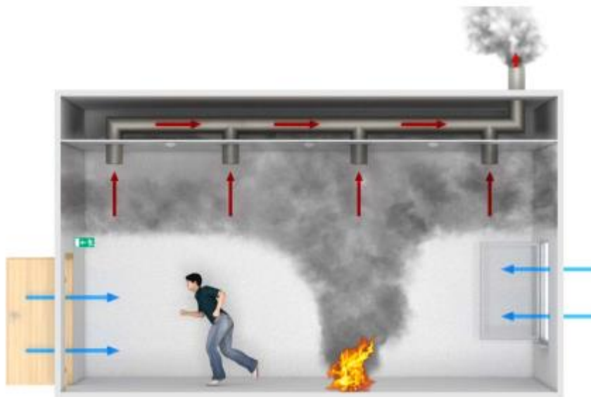
Рисунок 1.8 - Шарування димових газів (наприклад, у випадку механічної системи відводу диму).
