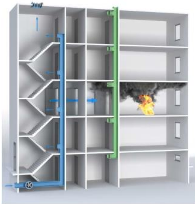
Рисунок 1.17 - Принцип показує контроль задимлення за допомогою диференціальних систем тиску.
