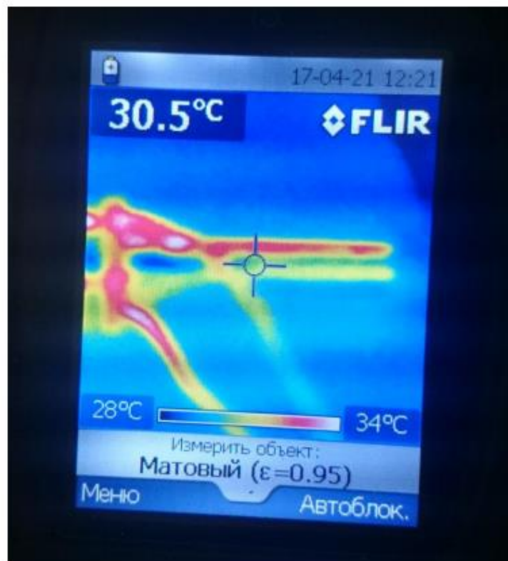
Рисунок 2.6 - Температура в середній частині охолоджувача
