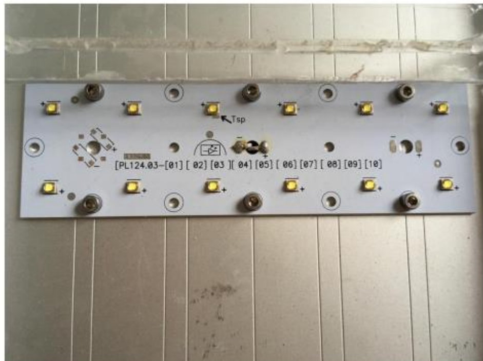
Рисунок 3.6 Позначення умовної точки пайки
