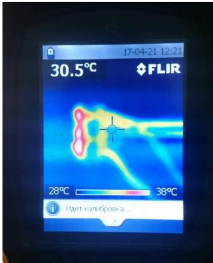
Рисунок 2.5 - Температура в найближчій частині охолоджувача до світлодіоду
