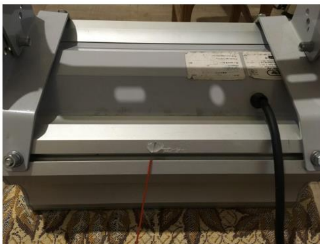
Рисунок 3.11 - Кріплення термопары на корпусі світильника
