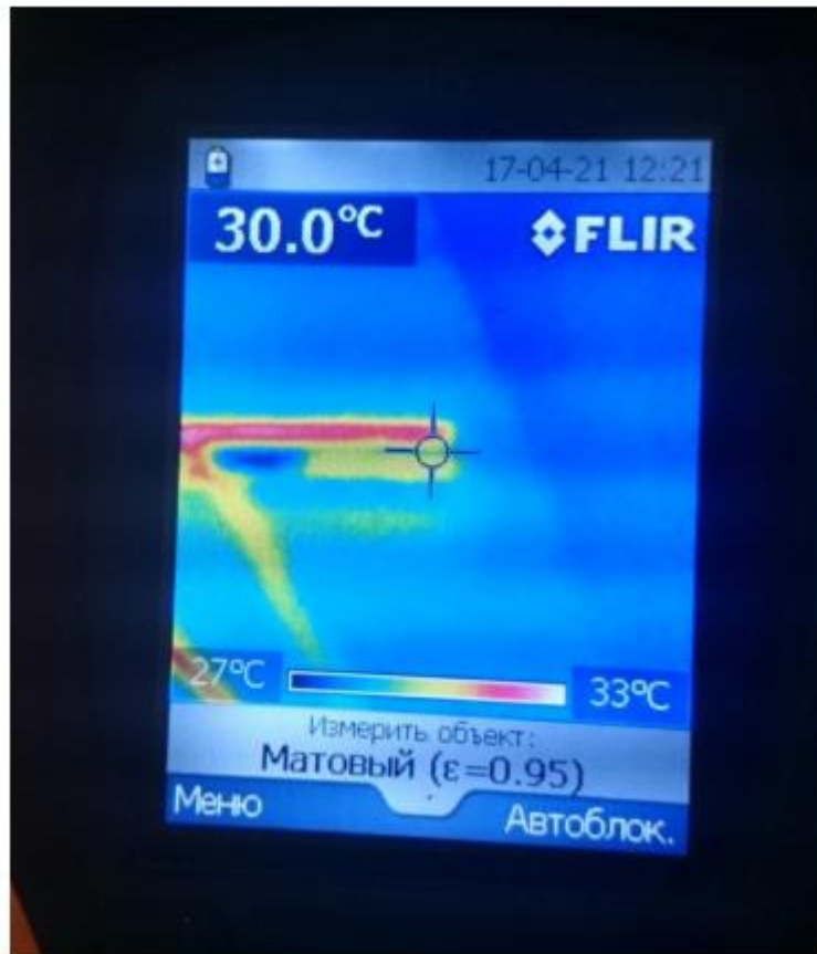
Рисунок 2.7 - Температура в кінцевій точці охолоджувача
