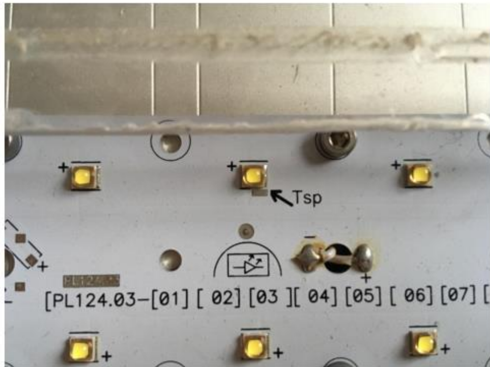
Рисунок 3.7 - Умовна точка пайки T_{SP} в збільшеному вигляді
