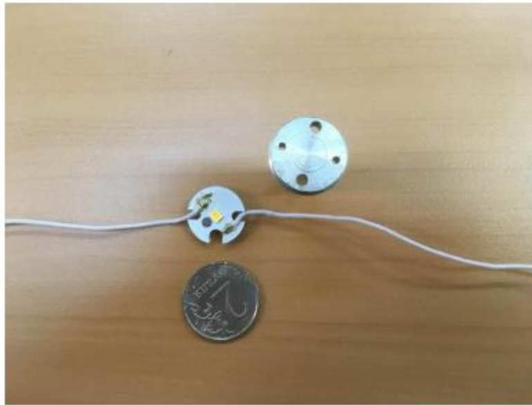
Рисунок 2.1 - Зовнішній вигляд одиничного світлодіода з платою
