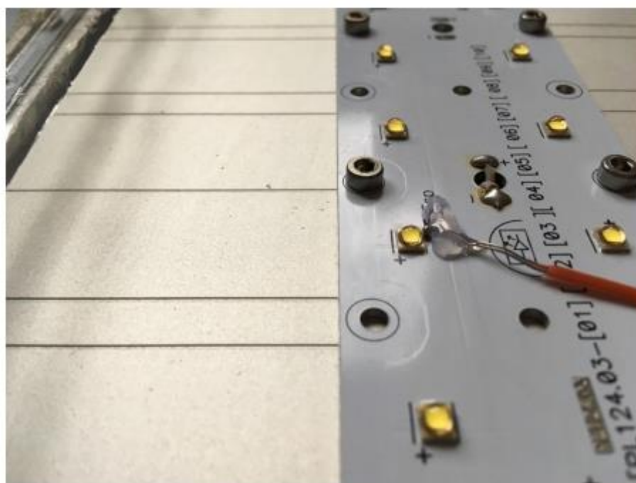
Рисунок 3.9 - Кріплення термопары вид збоку
