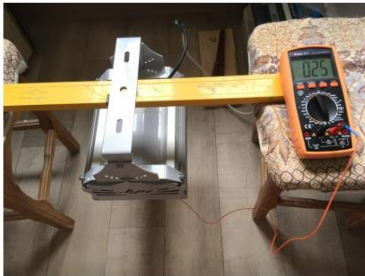
Рисунок 3.10 - Установка для вимірювання світлодіодного світильника
