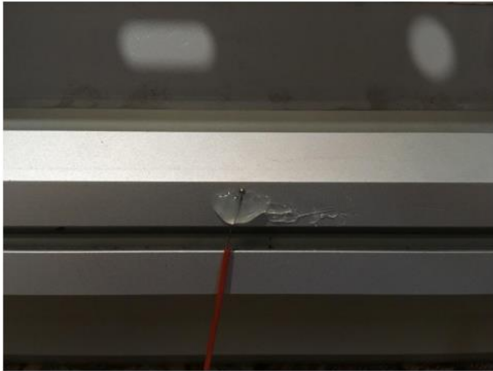
Рисунок 3.12 - Збільшений ракурс кріплення термопари на корпусі
