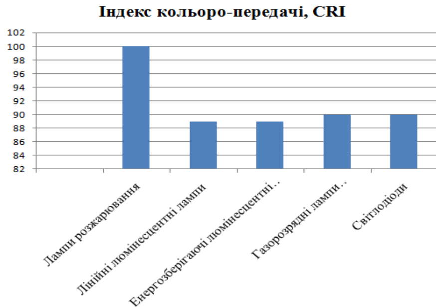
Рисунок 2.10 – Порівняння індексу кольоропередачі різних типів джерел світла
