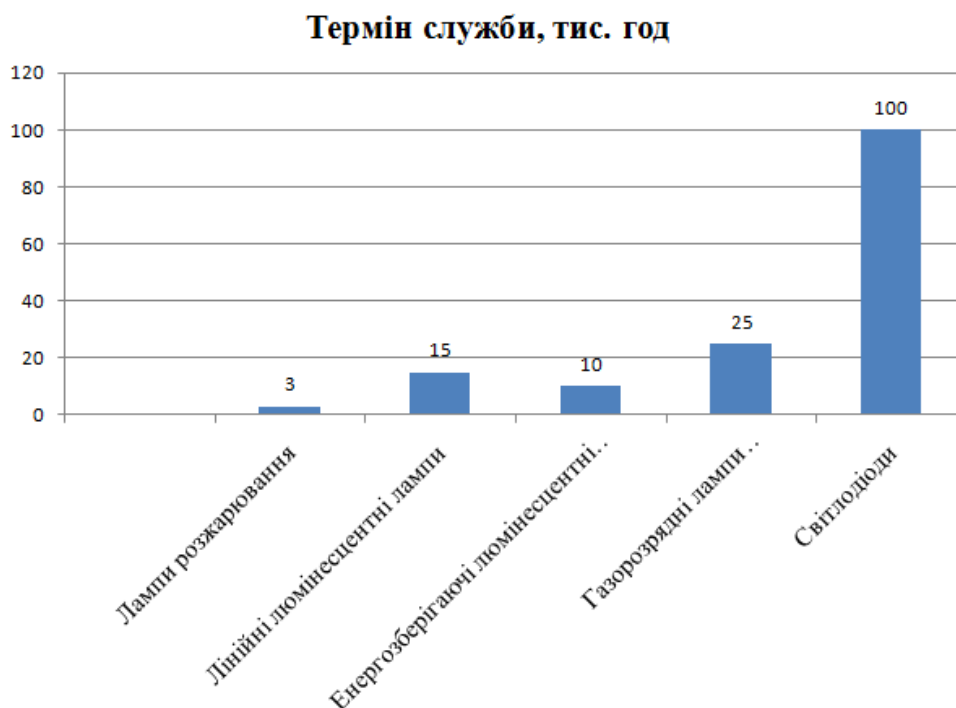
Рисунок 2.9 – Діаграма порівняння термінів служби різних джерел світла
