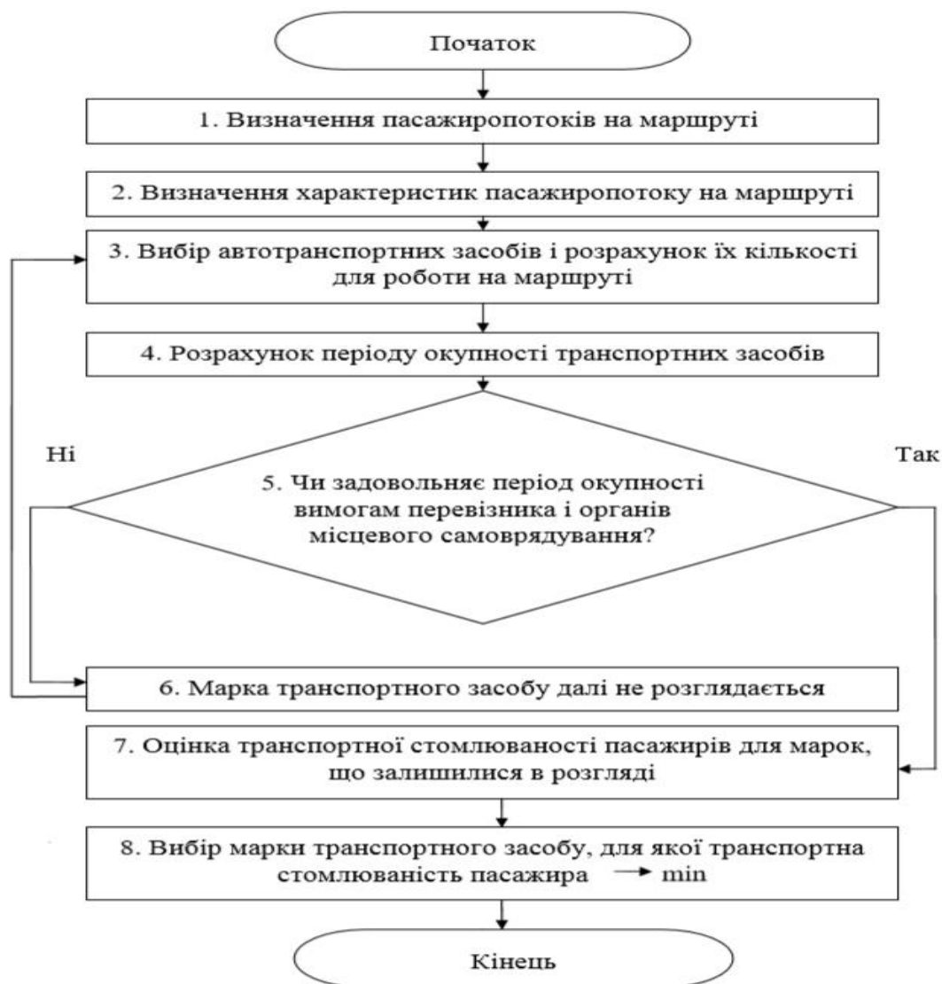
Рисунок 1.1. Схема алгоритму моделювання процесу вибору автотранспортного засобу для роботи на маршрутах міста
