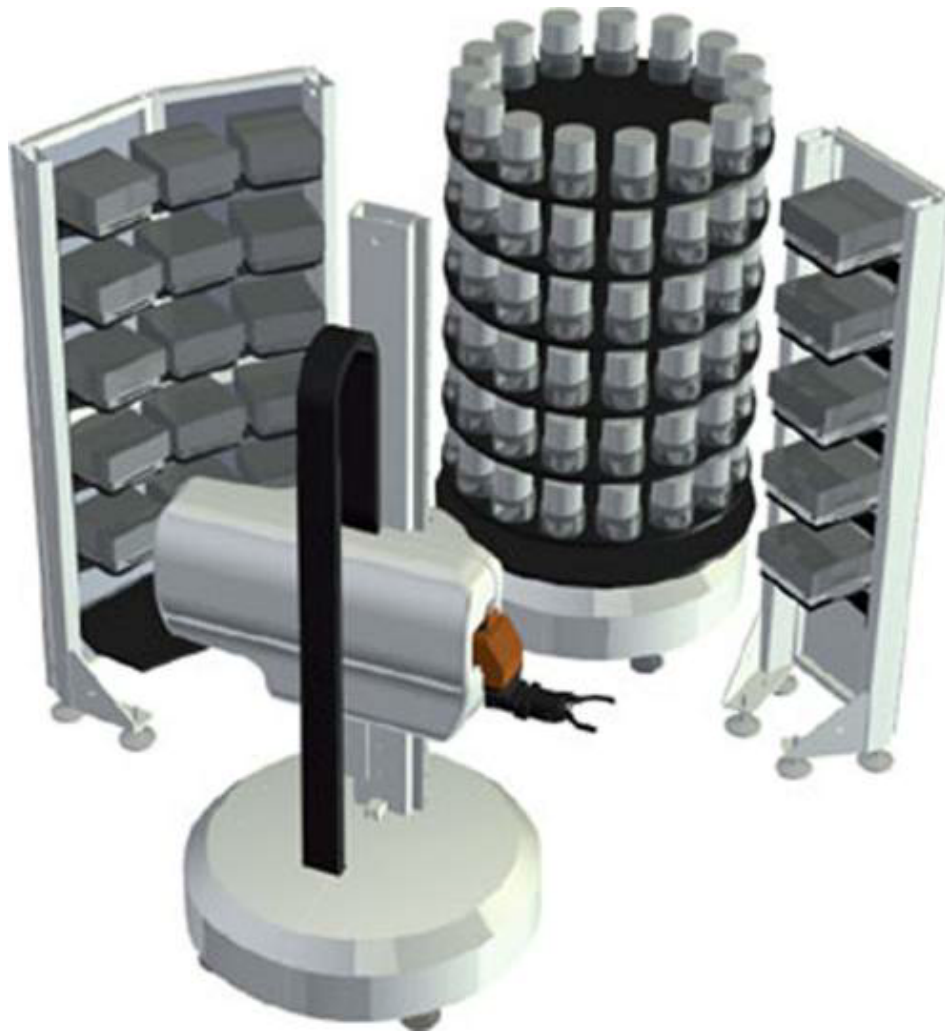
Рис. 1.5. Система 3R WorkMaster з робототехнічним важелем, що обслуговує три магазини піддонів для автоматизованого догляду за машиною
