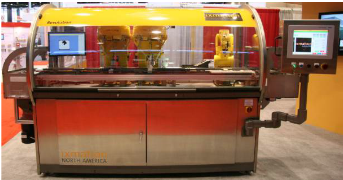
Рис. 1.2. Роботизована автоматизована система збірки ixmation з двома роботами в стилі дельта та роботом у стилі руки
