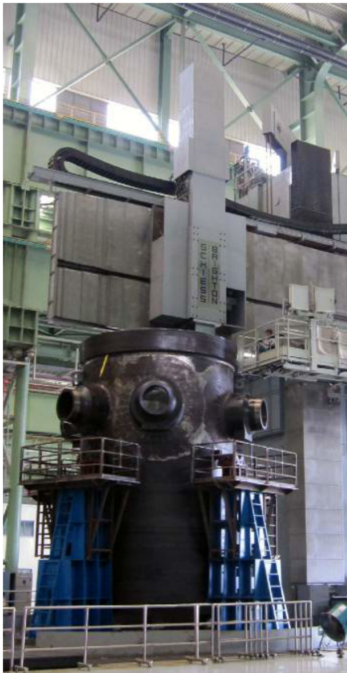
Рис. 1.4. Вертикальна розточувальна фреза від Schiess Brighton, яка обробляє дуже великі заготовки діаметром до 25 м
