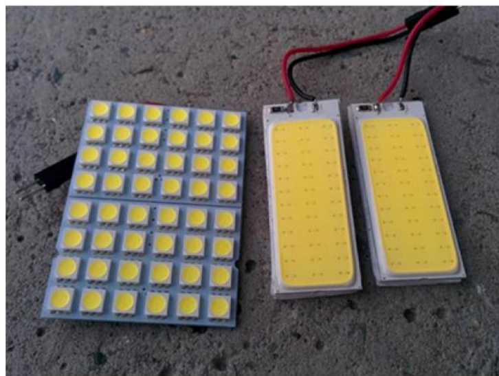
Рис. 1.8 СД матриця CDM 5050 (зліва), і СД матриця COB (справа).
