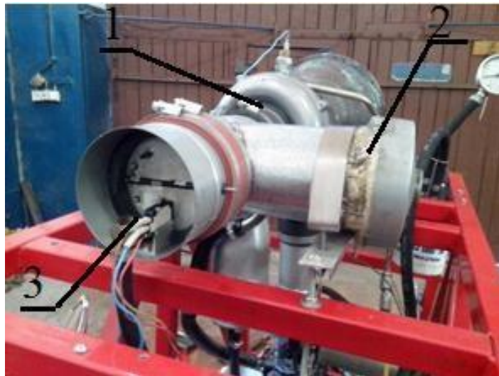
Рисунок 3.13 - Стартовий компресор з зворотним клапаном 1 – турбокомпресор; 2 – стартовий компресор; 3 – зворотний клапан з нормально замкнутим контактом
