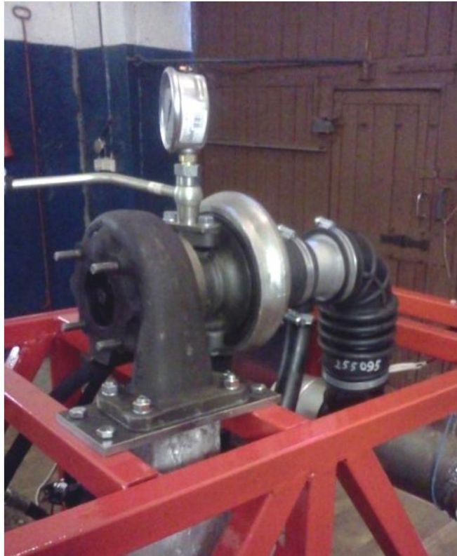
Рисунок 2.9 - Турбокомпресор K27-179-01, встановлений на МГТУ 5-30
