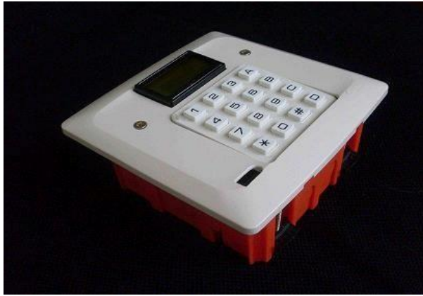
Рисунок 3.4 – Панель локального управління світильниками
