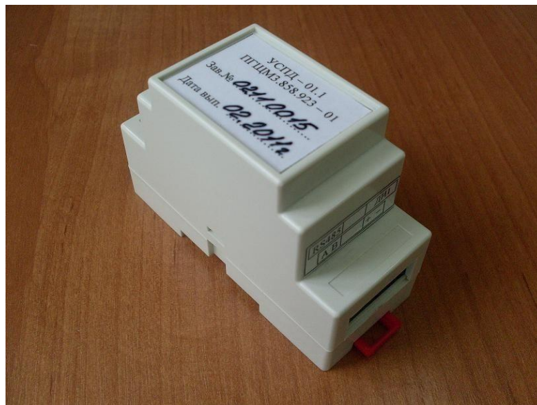
Рисунок 3.5 – Пристрій збору та передачі даних УСПД-01
