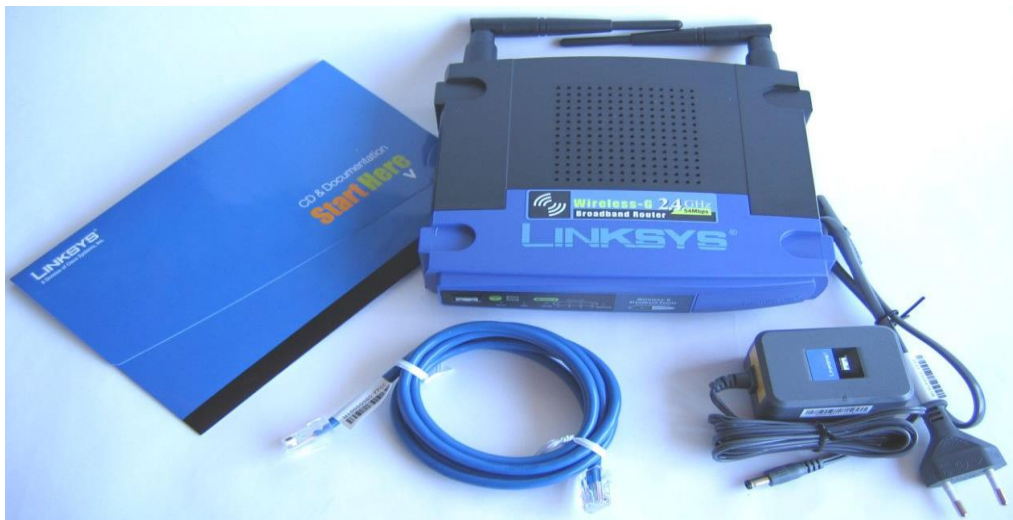
Рисунок 3.8 – Linksys WRT54GL та вміст упаковки
