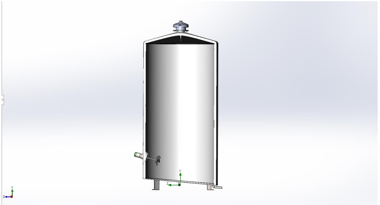
Рис. 4.2. Молочний резервуар великої місткості з мішалкою та форсункою системи СІР миття.
