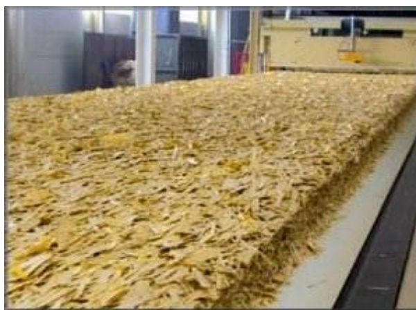
Рис. 1.2. Укладання тріски перед подачею в прес
