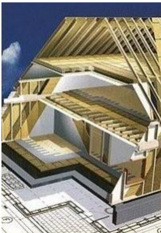
Рис.1.5. Каркасний дерев'яний будинок в розрізі
