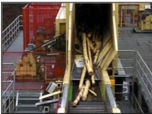
Рис. 1.1. Початок переробки деревини перед розпилюванням на щепу
