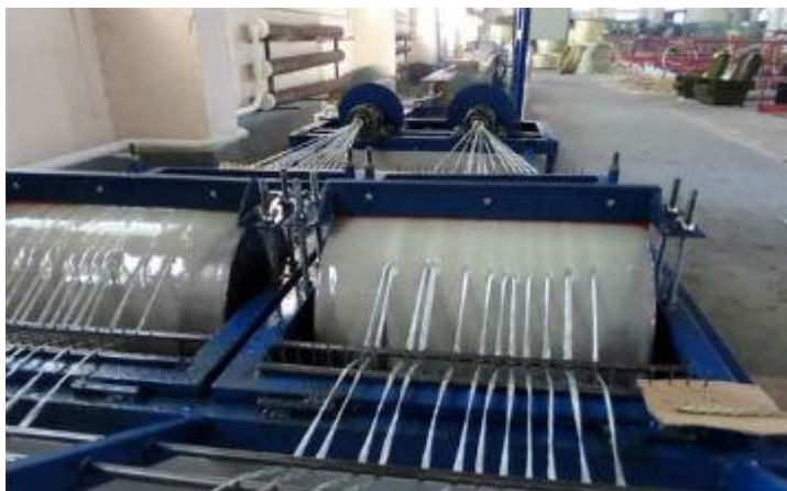
Рисунок 1.3 Змотування просоченого смолами ровінгу в пучок верстаком.
