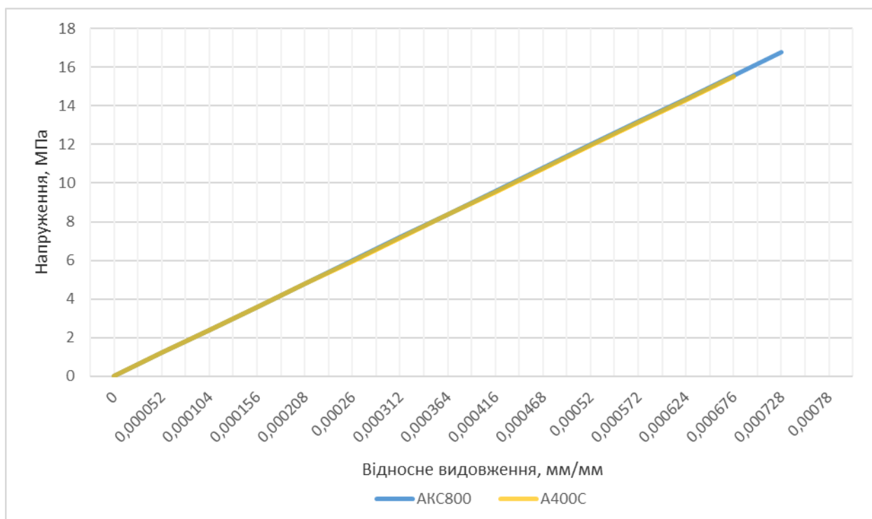
Рисунок 3.14 – Діаграми деформування бетону із сталеві і композитною арматурою
