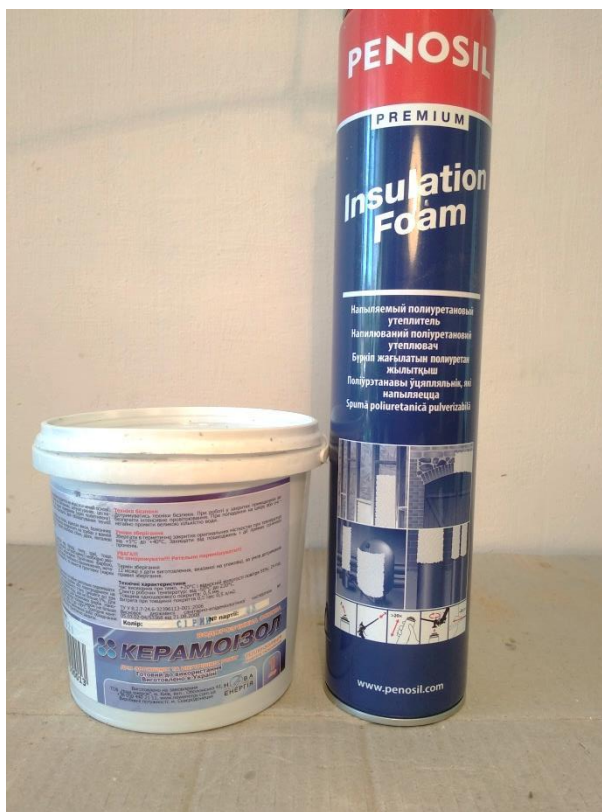
Рисунок 2.2 – Теплоізоляційні матеріали для дослідження Керамоізол (банка) і пінополіуретан (балон)
