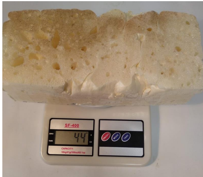
Рисунок 3.7 – Зразок пінополіуретану розміром 2500х120х65 мм
