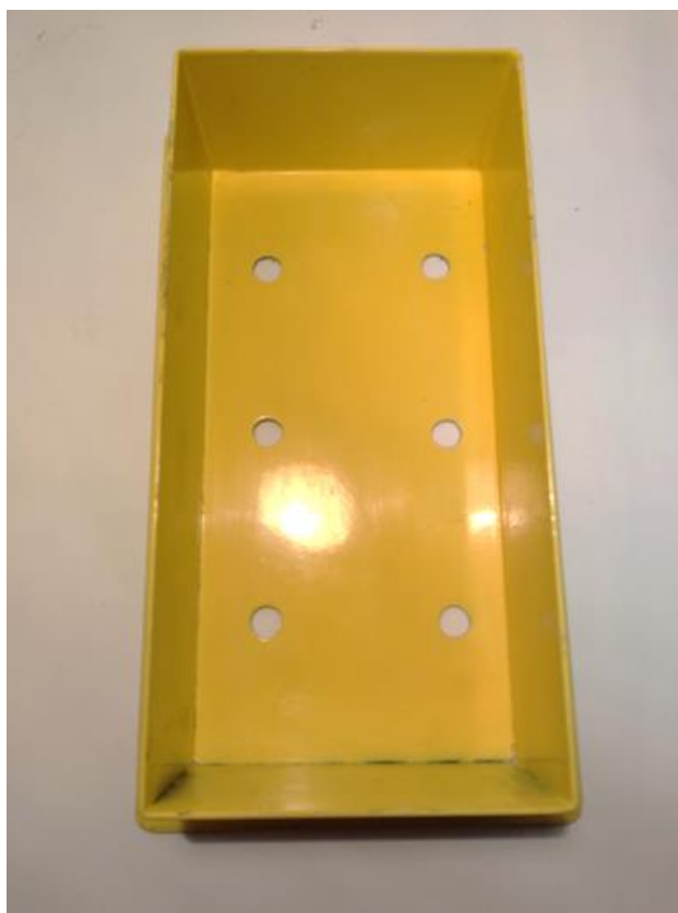
Рисунок 2.6 – Опалубка для виготовлення бетонного зразка
