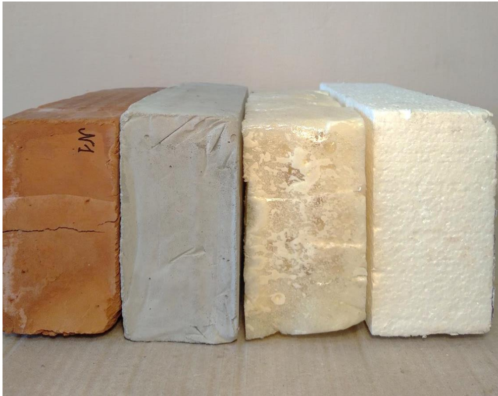
Рисунок 2.9 – Зразки для досліджень: цегла повнотіла , бетон, пінополіуретан, пінополістирол.
