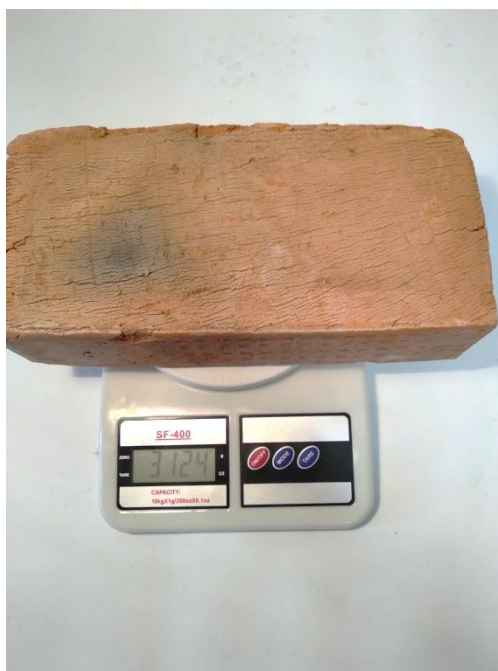
Рисунок 3.2 – Зважування цегли керамічної повнотілої
