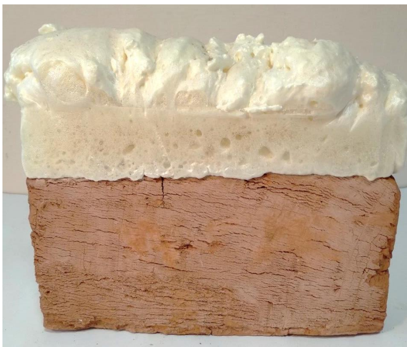
Рисунок 2.4 – Підготовка зразків з комбінації матеріалів цегла і пінополіуретан для вимірювання теплопровідності конструкції
