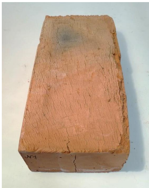
Рисунок 3.1 – Зразок для тарування приладу
