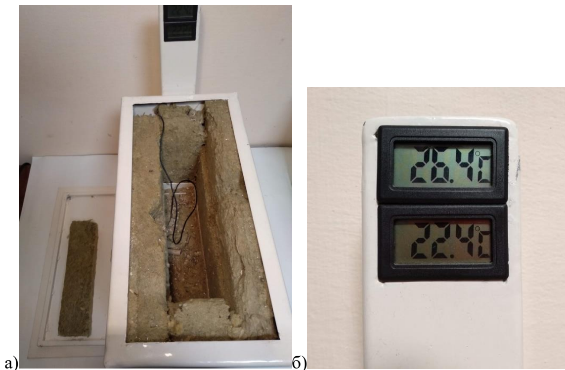
Рисунок 2.12 – Фото приладу для експериментального вимірювання коефіцієнту теплопровідності
