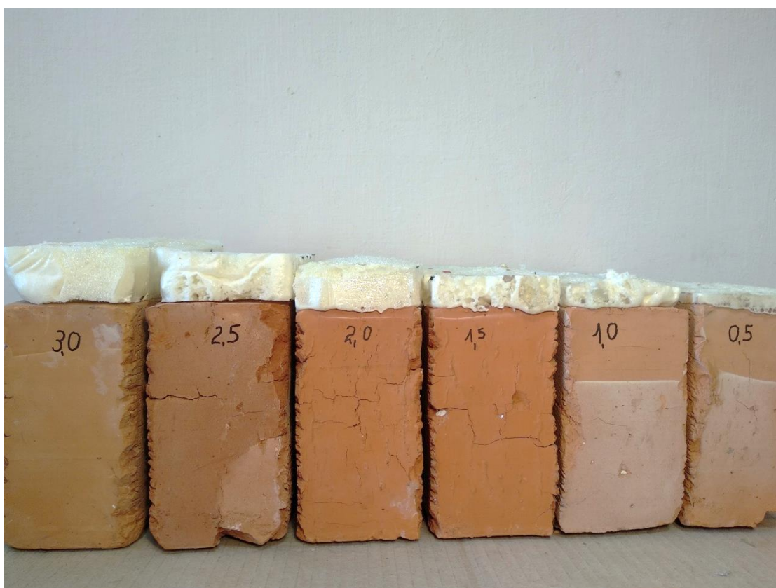
Рисунок 2.5 – Зразки для вимірювань теплопровідності в залежності від різної товщини ( зліва на право) 30 мм, 25 мм, 20 мм, 15 мм, 10 мм, 5мм відповідно
