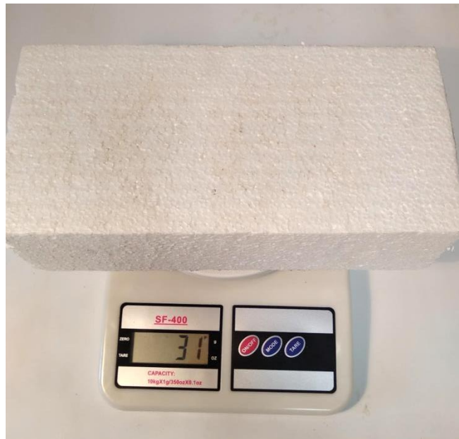
Рисунок 3.3 – Зразок пінополістиролу розміром 2500x120x65 мм
