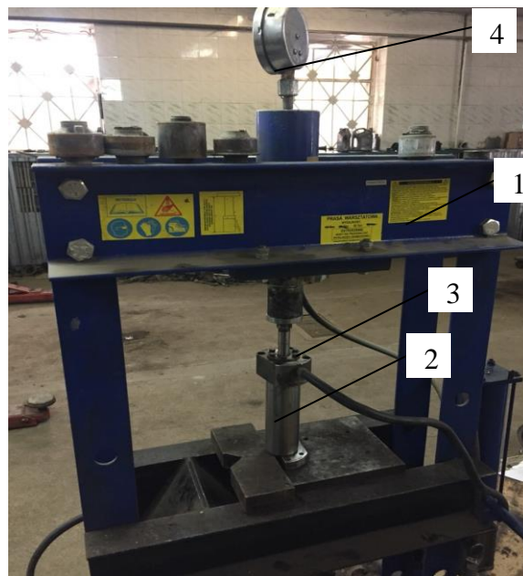
Рис. 3.4. Загальний вигляд процесу формоутворення сферичної поверхні корпусу: 1 – прес формоутворення сферичної поверхні корпусу; 2 – циліндрична заготовка; 3 – спеціальний інструмент для формоутворення поверхні; 4 – вимірювальний пристрій
