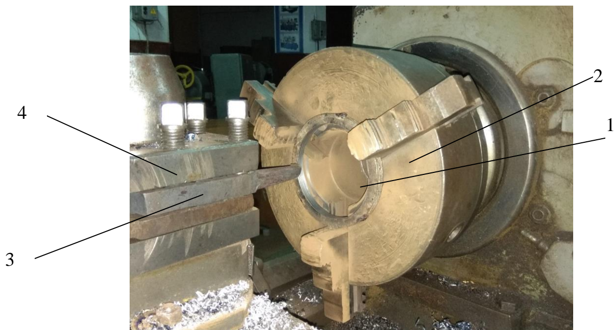
Рис. 3.12. Процес розточування внутрішнього отвору заготовки гвинтового секційного робочого органу на токарно-гвинторізному верстаті:
