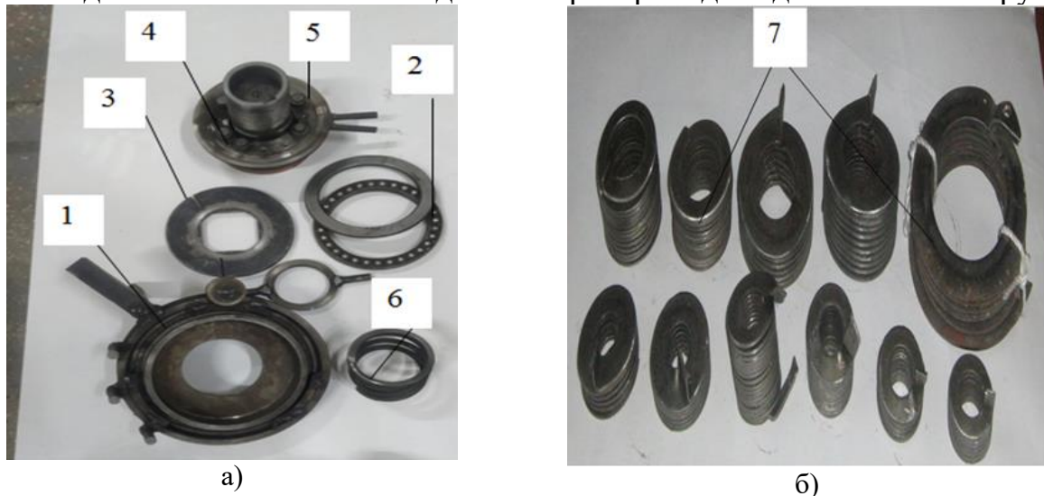
Рис. 18. Загальний вигляд пристрою з обертовою втулкою у розібраному вигляді для процесу навивання гвинтової заготовки – а) навиті гвинтові заготовки - б) : 1 – зовнішня обойма; 2 – підшипник; 3 – кільце; 4 – направляючі втулки; 5 – внутрішня обойма; 6 – пружина; 7 – гвинтова секційна заготовка
