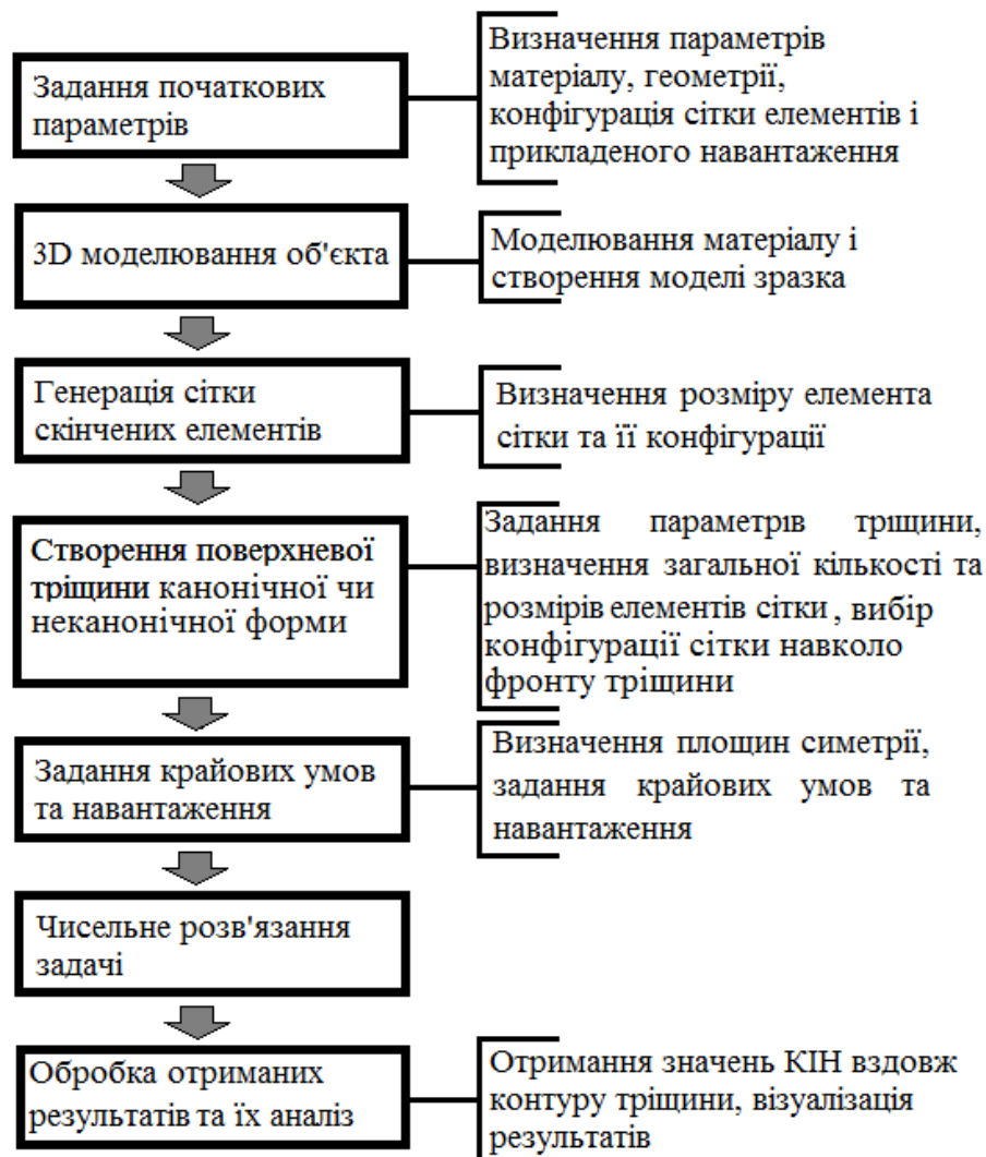
Рис. 2.1. Основний алгоритм визначення КІН для поверхневих тріщин канонічної та неканонічної форм методом скінчених елементів
