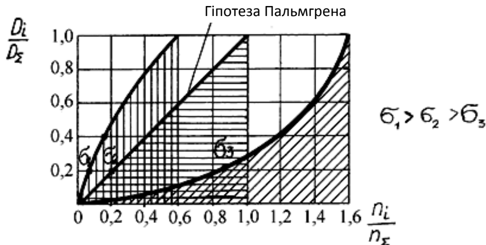
Рисунок 1. Залежність пошкоджень при втомі від відносного числа циклів
