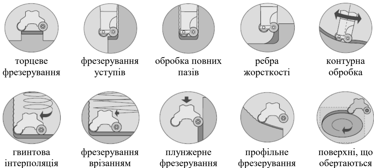
Рисунок 2.9 – Основні технологічні операції, що здійснюються фрезами з круглими ріжучими пластинками для торцевого фрезерування і обробки профілів з низькими зусиллями різання
