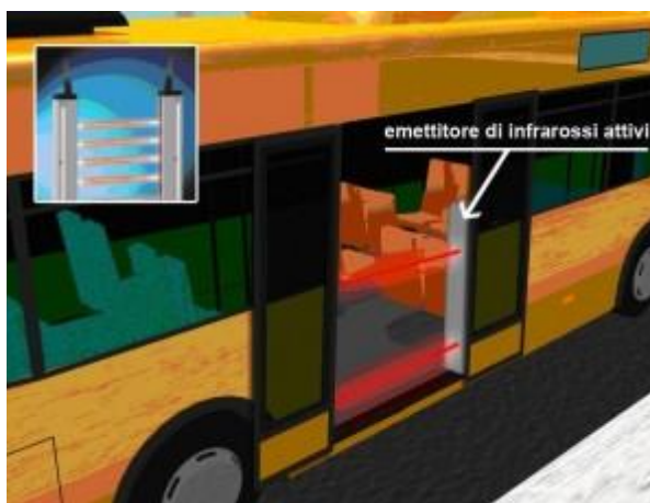
Рисунок 2.5 – Ілюстрація роботи інфрачервоних датчиків
