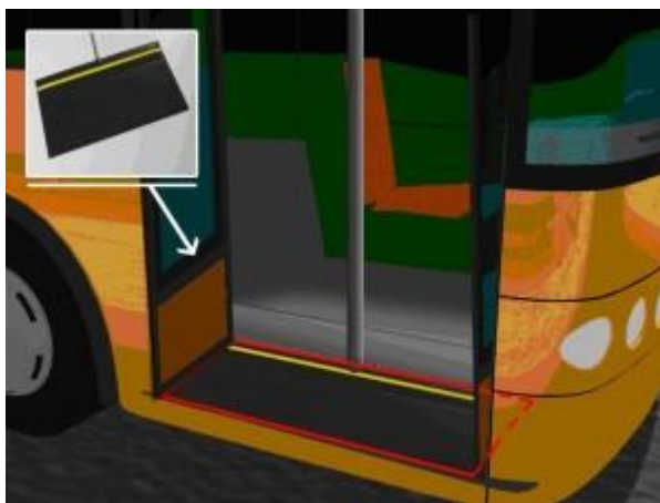
Рисунок 2.4 – Ілюстрація розміщення нажимних плит
