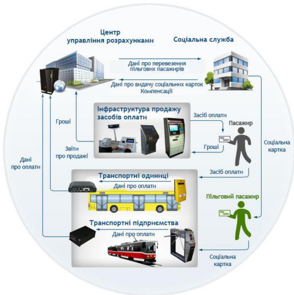
Рисунок 2.8 – Схема роботи АСОП від «CS-Trans»
