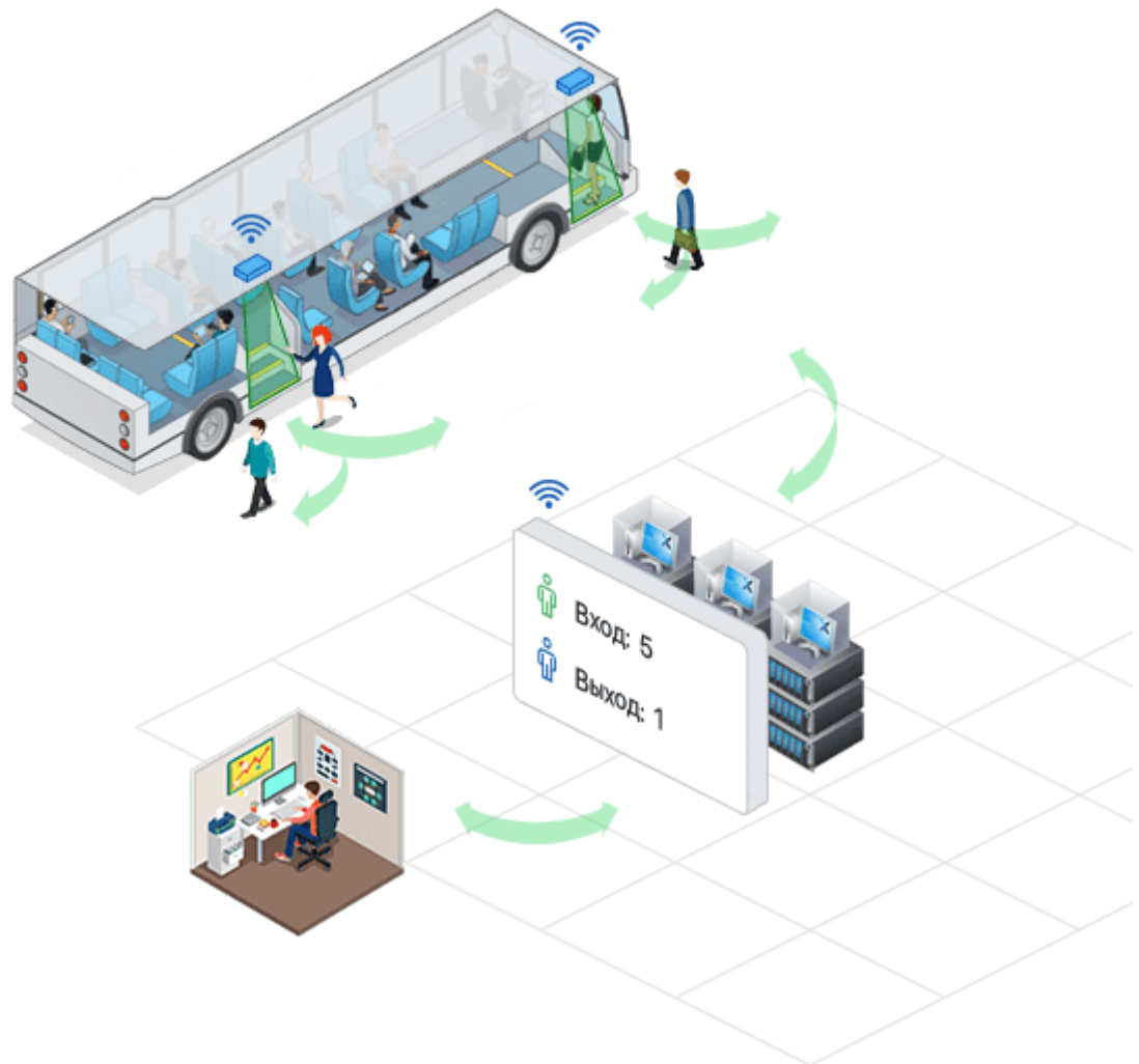
Рисунок 2.9 – Схема роботи системи «Intranso Smart Counter»
