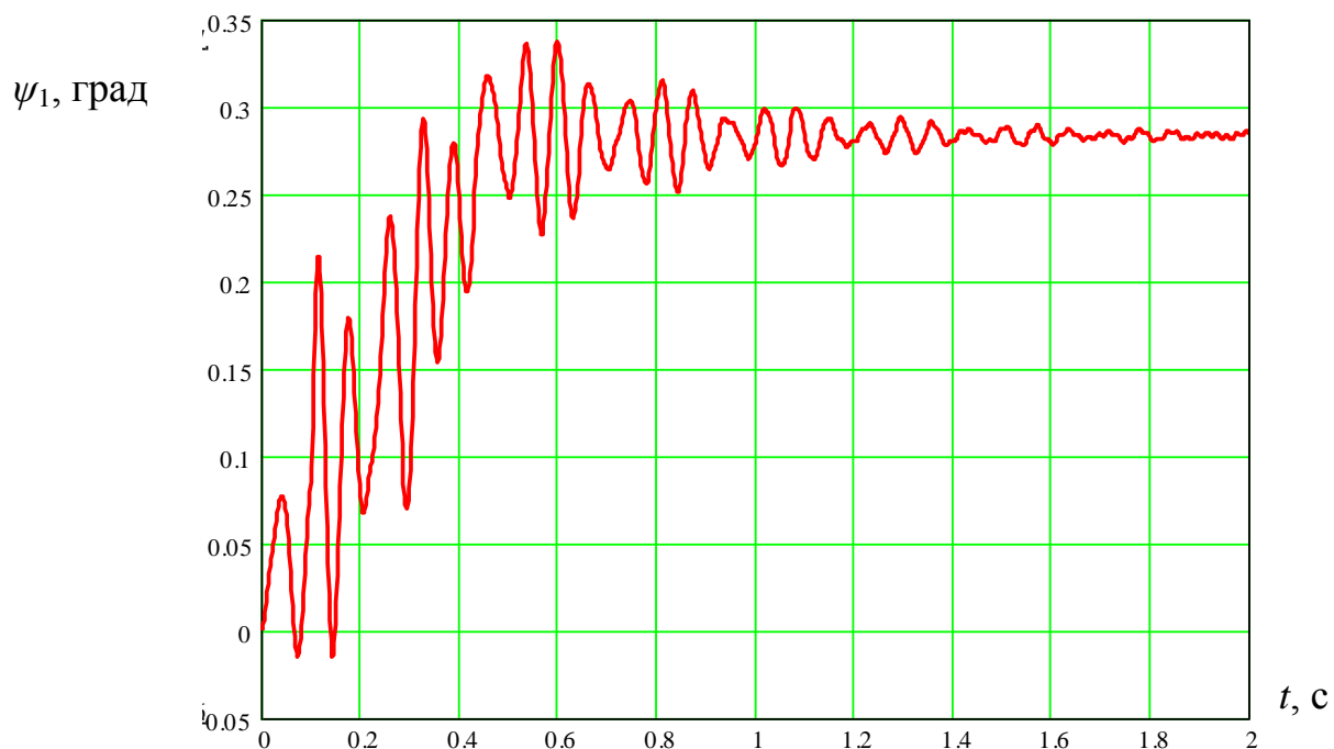
Рисунок 2.3 - Графік зміни кута деформації свердла відносно зенкера в часі
