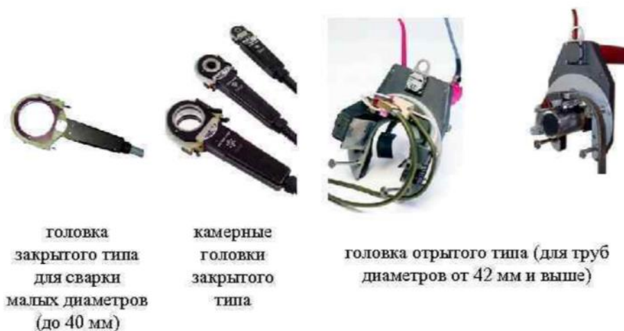
Рисунок 2.11 - Зовнішній вигляд головок для орбітального зварювання
