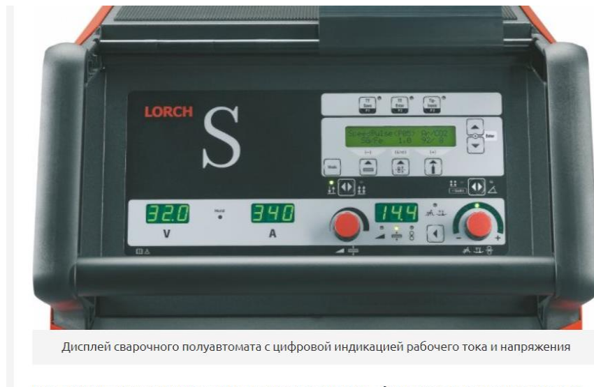
Рисунок 3.2 – Дисплей зварювального напіавтомату з цифровою індикацією робочого струму и напруги зварювання
