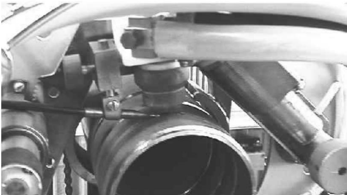
Рисунок 2.13 - Пальник для автоматичного регулювання дуги саморегулювання, що входить до складу зварювальної головки
