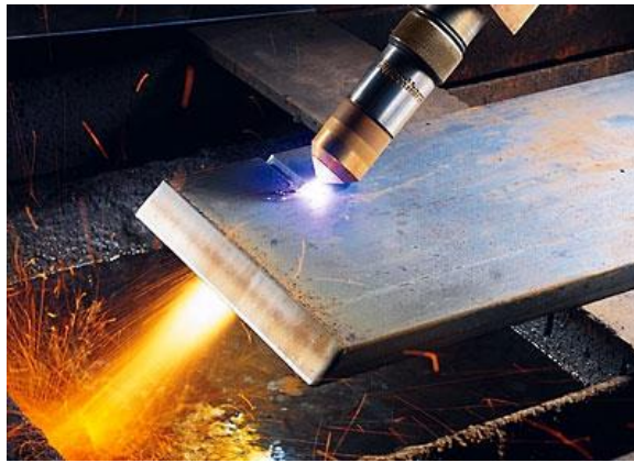
Рис. 3.9 – Плазмове різання під кутом системою Hypertherm
