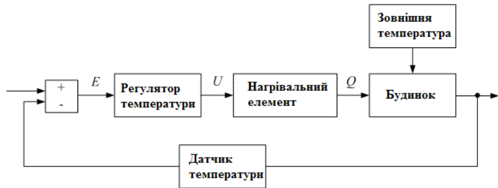
Рис.3.4. Структурна схема САУ теплової моделі будинку.
