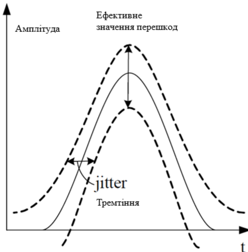
Рисунок 3.1 Часове тремтіння (jitter).
