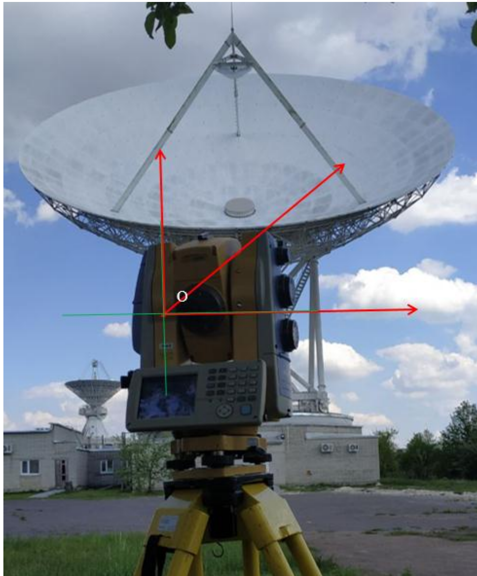
Рисунок 3.13 Сканування поверхні рефлектора АС за допомогою тахеометра Topcon IS-301
