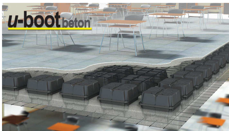
Рис. 3.3 Система U-boot Beton
