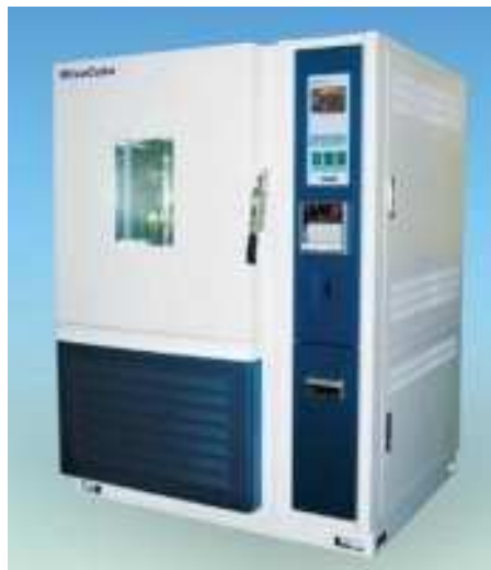
Рисунок 3.1 - Кліматична установка для проведення випробувань
