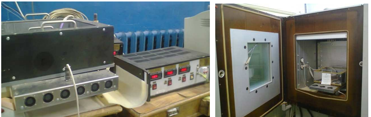
Рисунок 3.2 – Установки для визначення теплопровідності
