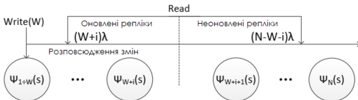
Рисунок 2.2 - Модель узгодження реплік в кінцевому рахунку ( W + R \leq N , синхронний режим)
