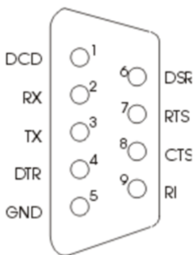
Рисунок 4.11 – Розташування виводів для RS-232
