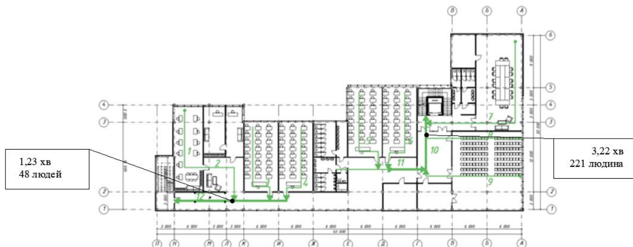
Рисунок 4.2 Схема та розрахунковий час евакуації людей з 2-го поверху
