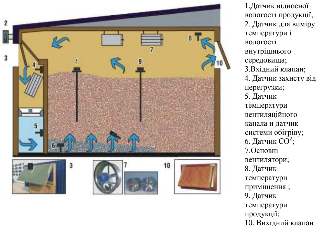
Рисунок 4.1 Схема вентиляції відсіку овочесховища
