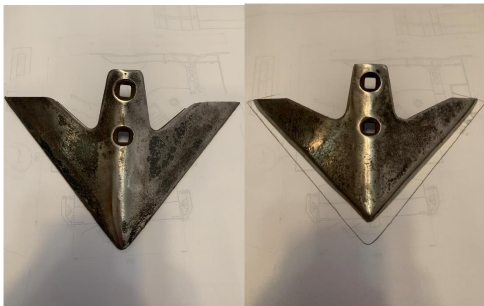
Рис 2.2 – Стрільчаті лапи культиватора: а – нова; б – після експлуатації
