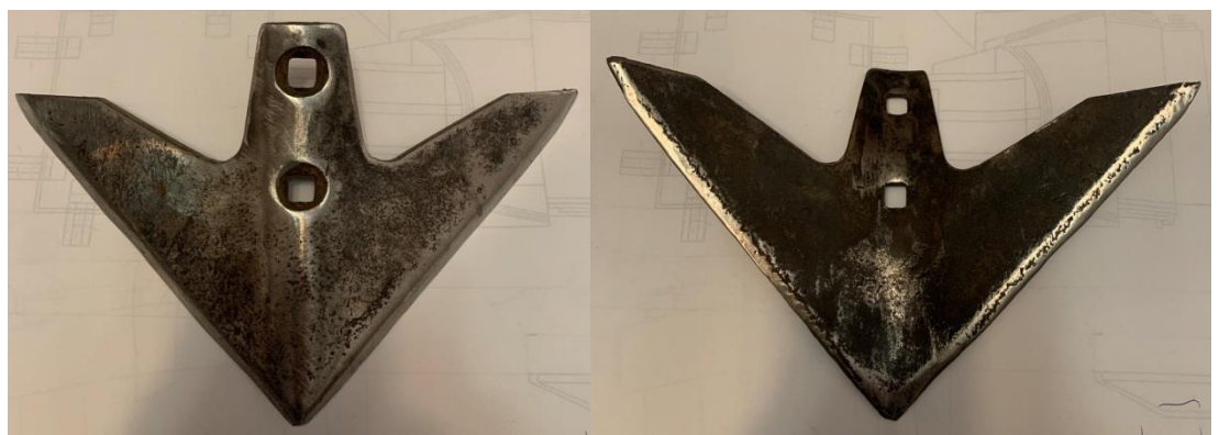
Рисунок 2.6 - Стрільчасті лапи культиватора, зміцнені індукційним методом з лицьової і тильної сторони а); зношені лапи культиватора з лицьової і тильної сторони
