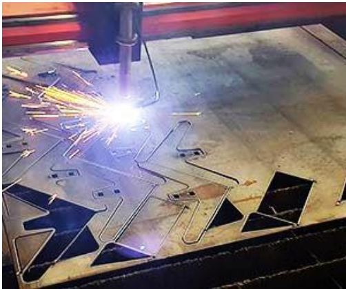
Рис 3.4 – ЧПУ плазмове різання
