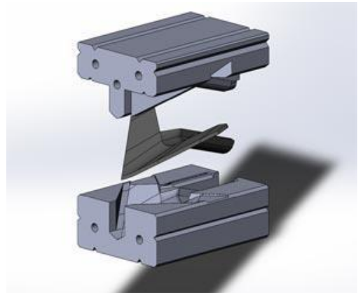
Рис. 3.5 – Наскрізне 3D моделювання штампів і прес форм
