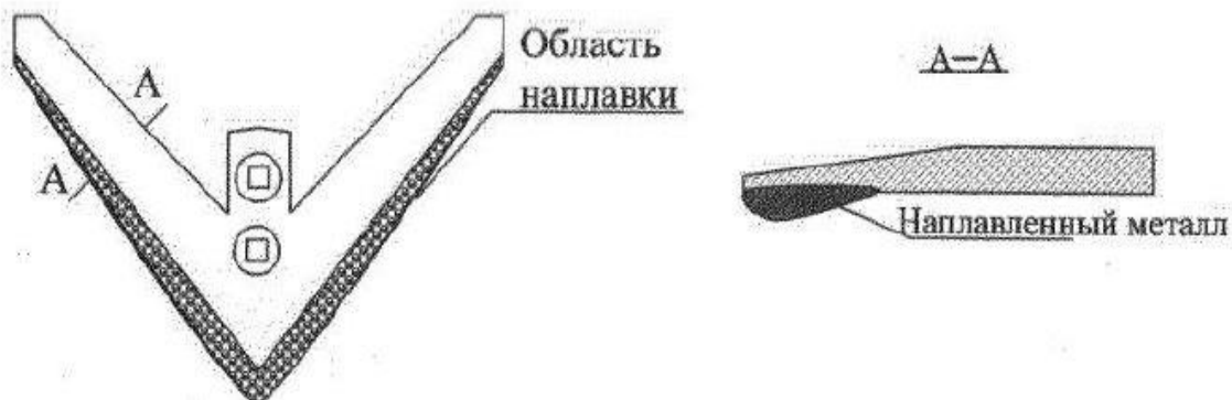
Рисунок 1.10– Лапа з навареним запасом металу з тильної сторони
