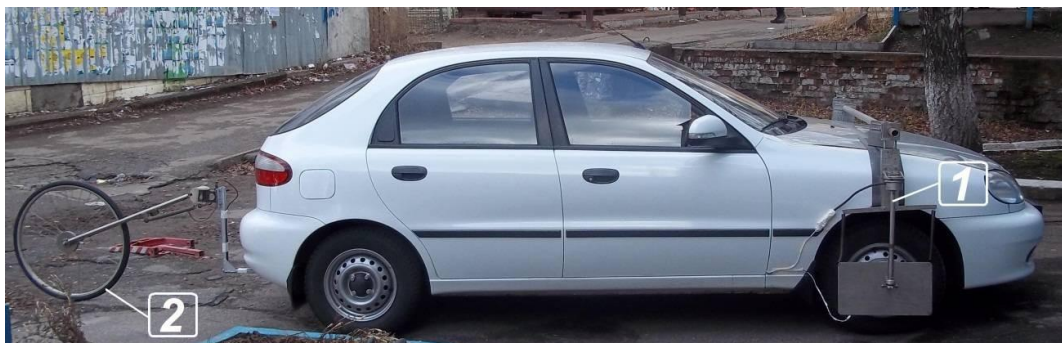
Рис. 4. 1. Загальний вид автомобіля з дослідницьким обладнанням 1- Датчик, що використовується для вимірювання кута зближення колеса та його обертання; 2- "П'яте" колесо, яке вимірює центр
