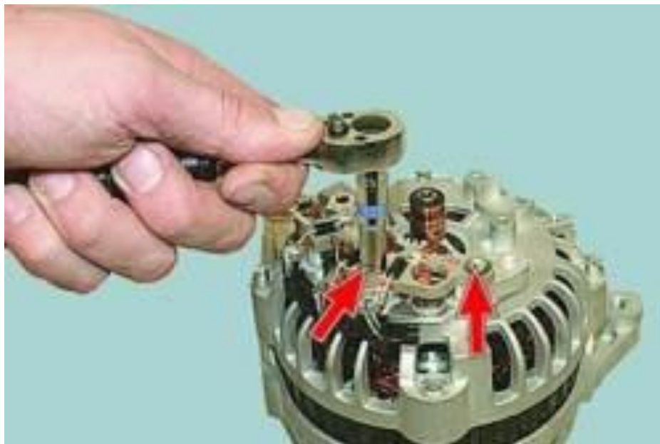
Рисунок 2.38 – Відкручування випрямного блоку
