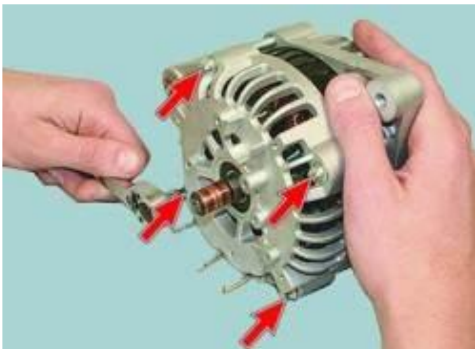
Рисунок 2.44 – Відкручування стяжних гвинтів
