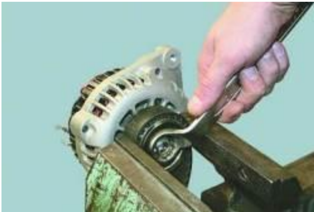
Рисунок 2.48 – Відкручування гайки шківа
