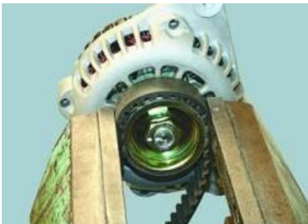
Рисунок 2.47 – Затиснутий шків в лещатах
