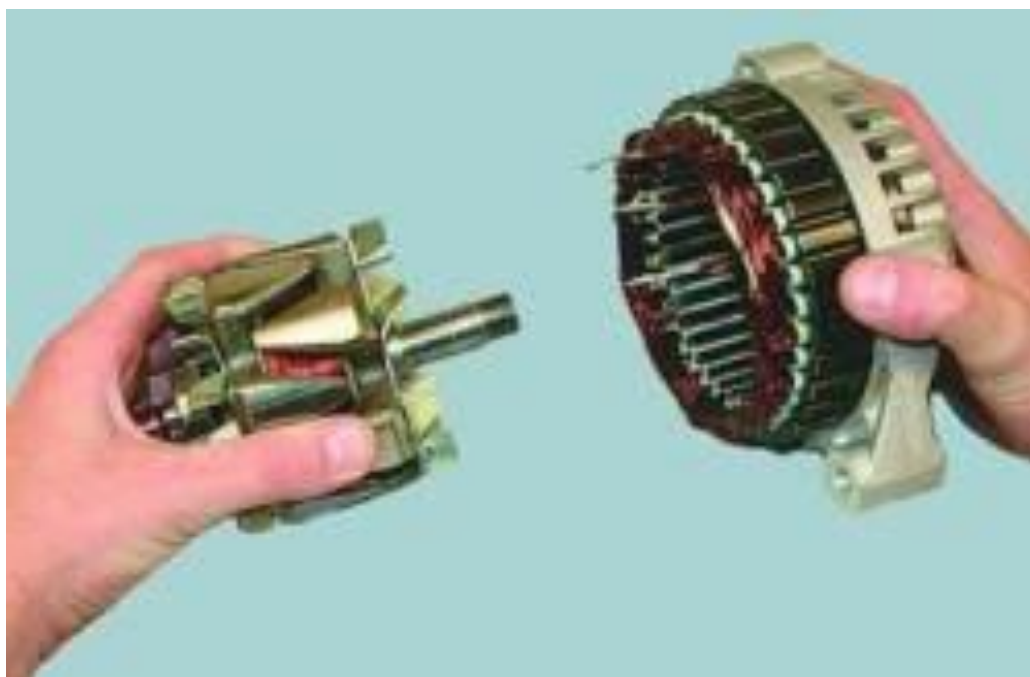
Рисунок 2.51 – Виймання ротора з передньої кришки
