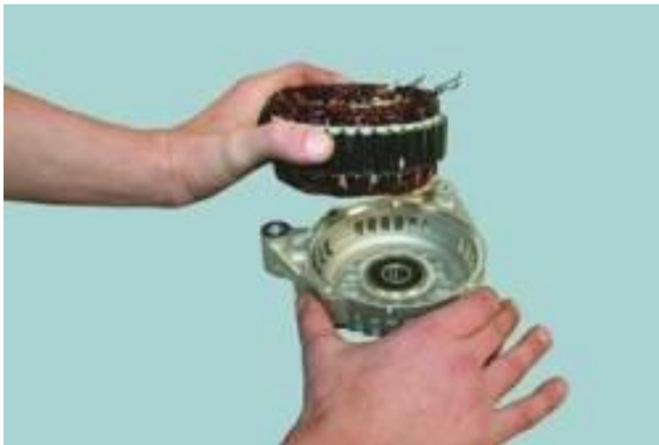
Рисунок 2.58 – Роз'єднання статора і передньої кришки
