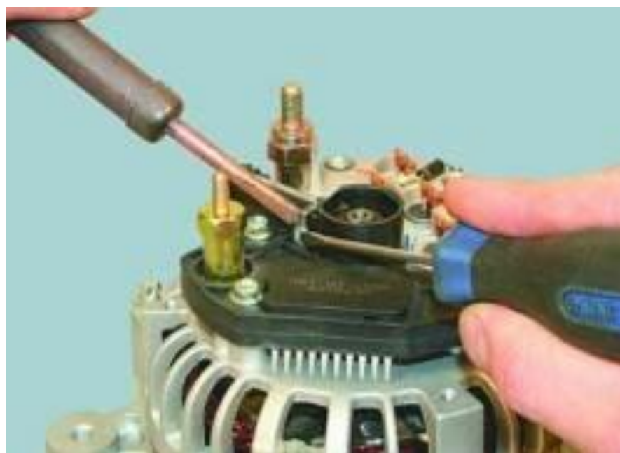
Рисунок 2.15 – Відпаювання щіткового вузла
