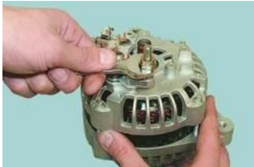
Рисунок 2.36 – Відкручування контактної шпильки
