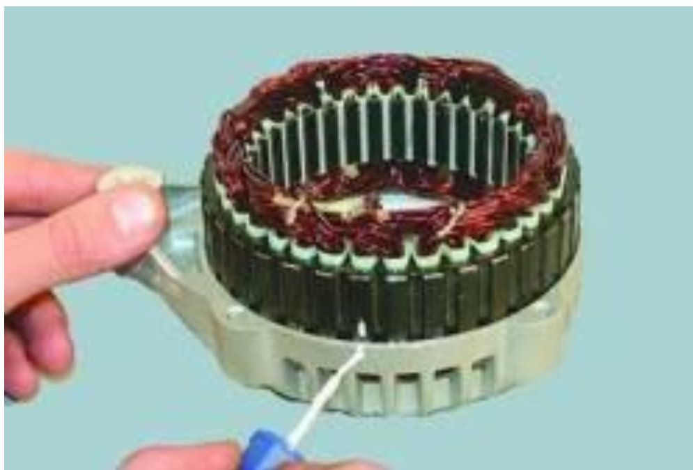
Рисунок 2.56 – Позначення розташування статора і передньої кришки
