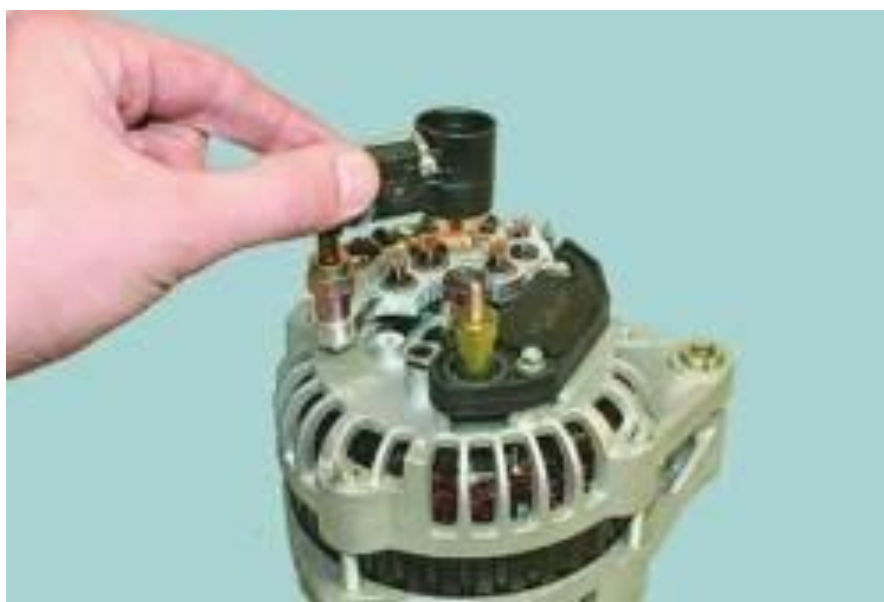
Рисунок 2.17 – Зняття щіткового вузла
