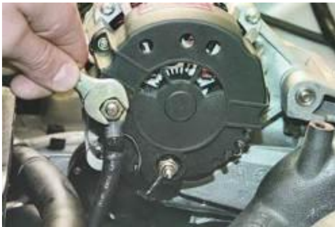
Рисунок 2.2 – Відкручування силових дротів
