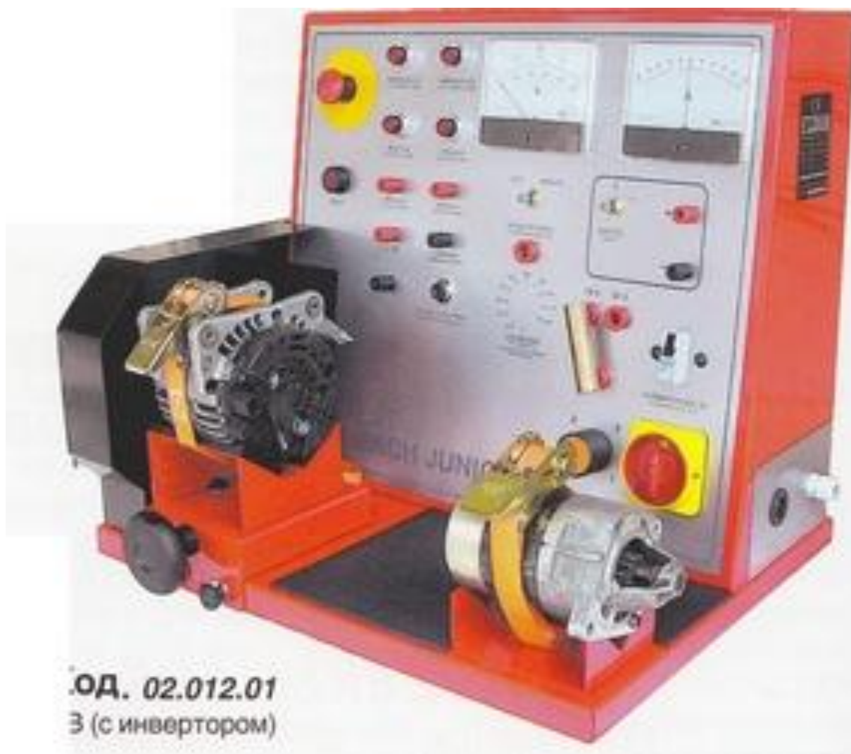
Рисунок 3.1 – Стенд 02.012.00 (SPIN – Італія)
