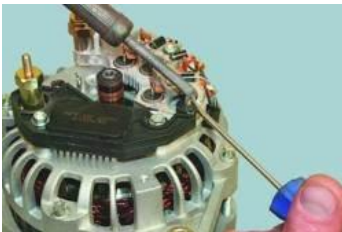
Рисунок 2.31 – Відпаювання виводу РН
