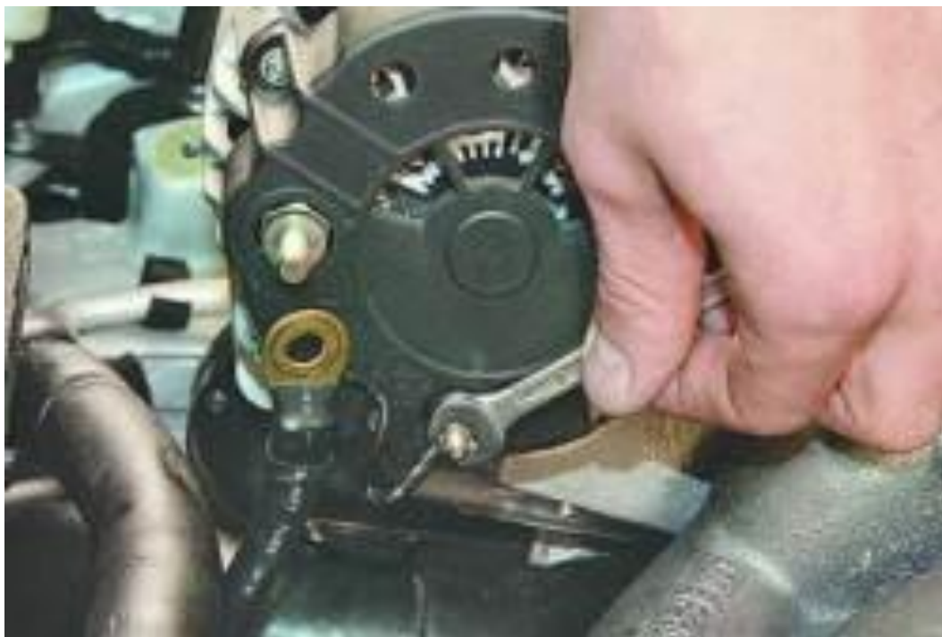
Рисунок 2.4 – Відкручування гайки кріплення наконечника
