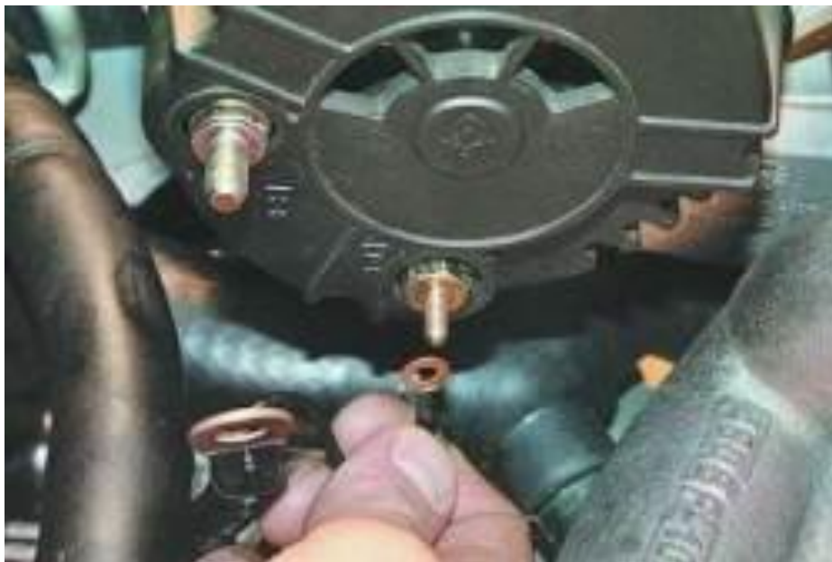
Рисунок 2.5 – Зняття наконечника дроту
