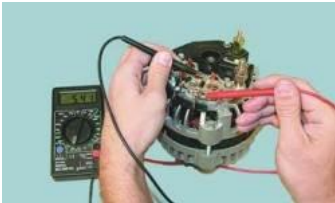
Рисунок 2.27 – Перевірка додаткових діодів
