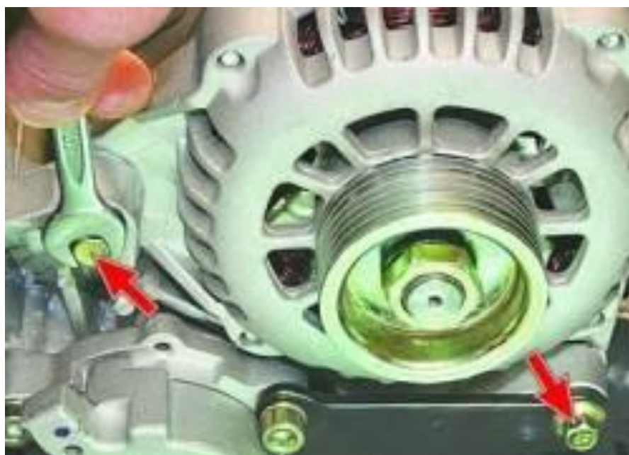
Рисунок 2.6 – Відкручування двох болтів кріплення
