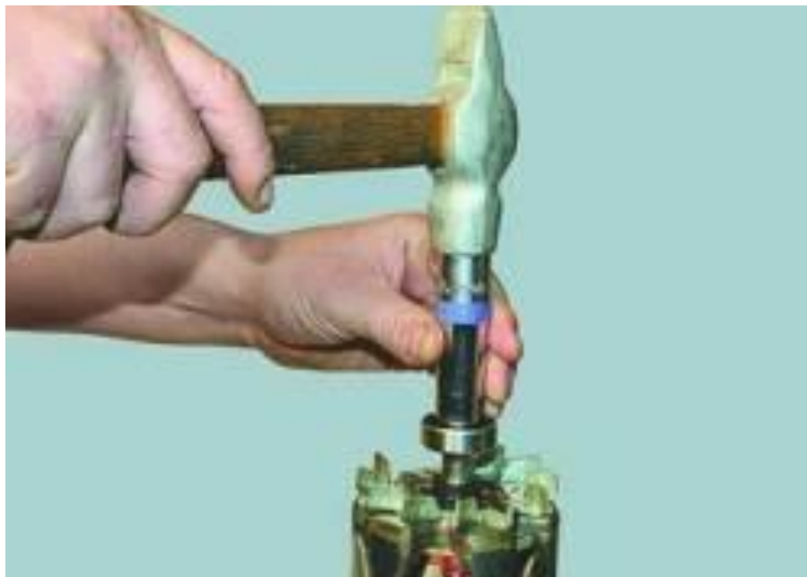
Рисунок 2.55 – Напресовування нового підшипника
