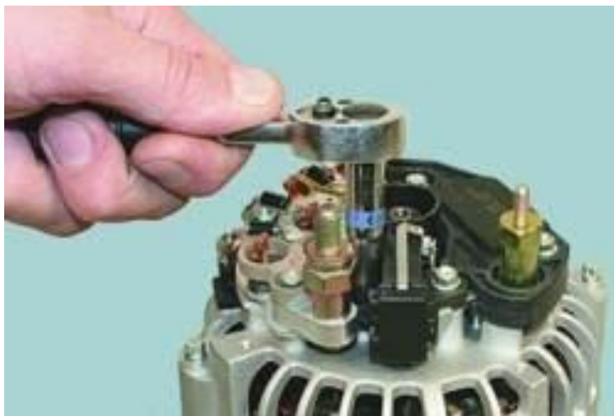
Рисунок 2.16 – Відкручування гвинтів кріплення щіткового вузла
