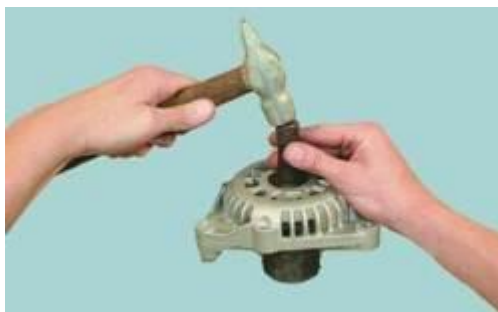
Рисунок 2.60 – Випресовування заднього підшипника
