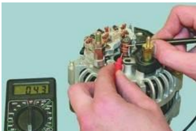
Рисунок 2.23 – Перевірка обмотки ротора
