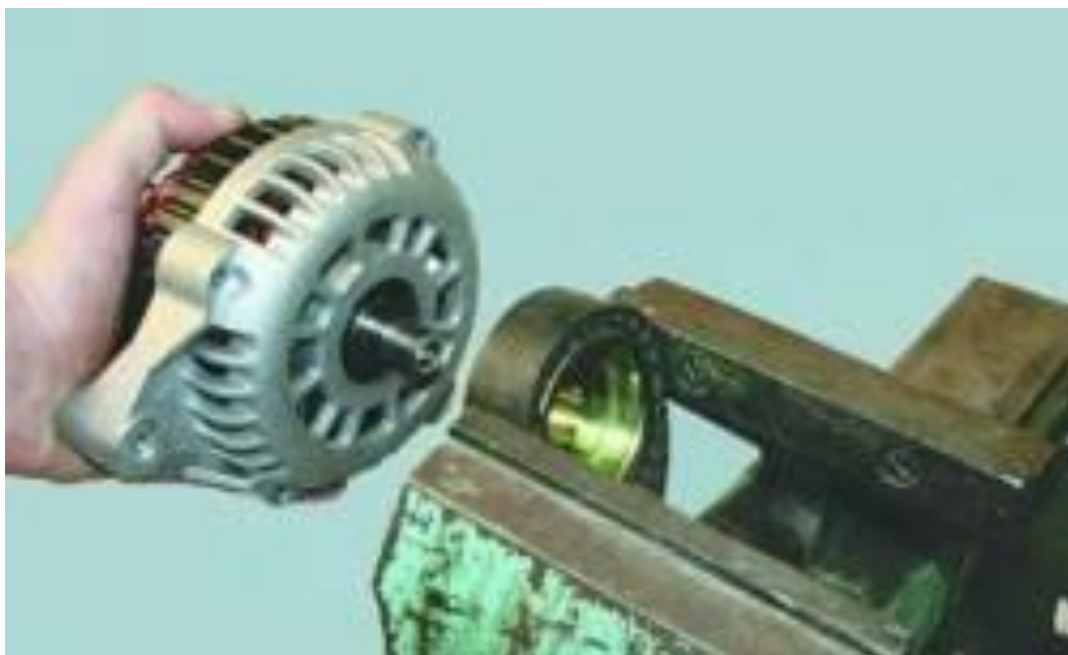
Рисунок 2.49 – Виймання вала ротора
