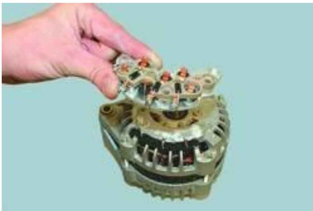
Рисунок 2.39 – Зняття випрямного блоку
