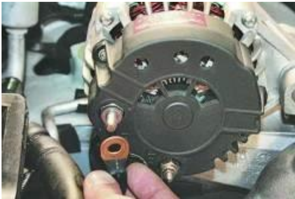
Рисунок 2.3 – Зняття наконечника дроту
