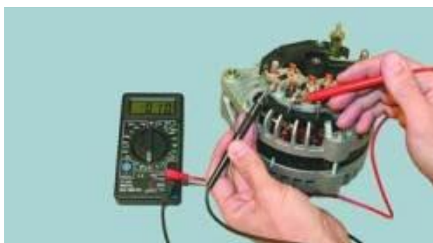
Рисунок 2.29 – Перевірка обмотки статора
