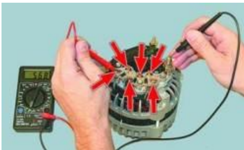
Рисунок 2.25 – Перевірка діодів випрямляча
