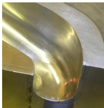
Рисунок 1.4 – Результат відновлення деталі лазерним наплавленням
