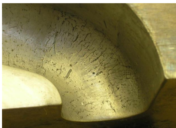
Рисунок 1.4 – Результат відновлення деталі лазерним наплавленням
