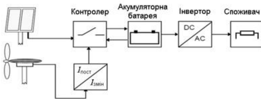
Рисунок 1.1 - Структурна схема гібридної системи з використанням енергії вітру та сонця
