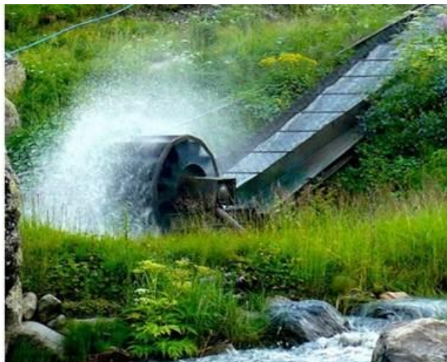
Рисунок 2.5 – Приклад формування нахилу потоку води для мікро-ГЕС
