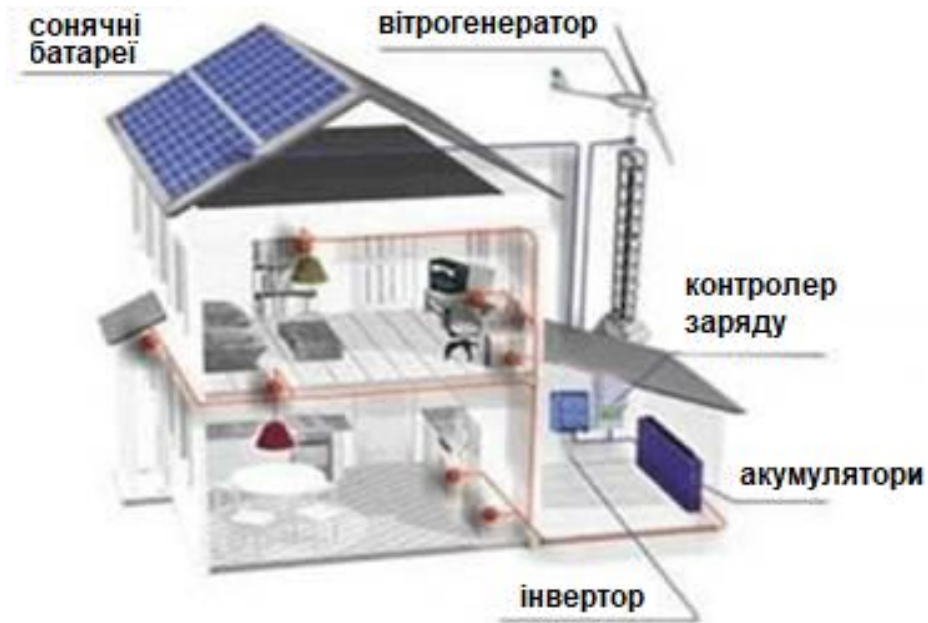
Рисунок 1.7 - Схема автономного електропостачання будинку
