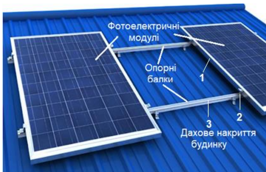
Рисунок 2.12 - Кріплення фотомодулів на похилій покрівлі
