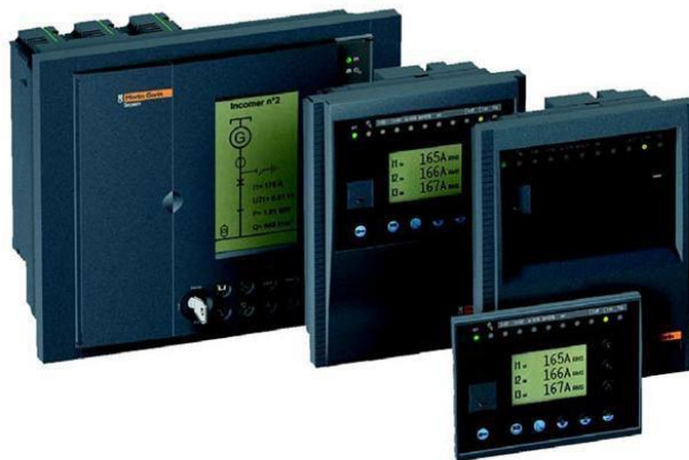
Рисунок 2.7 - Пристрої мікропроцесорного захисту серії Seram 20,40,80 Застосування новітньої елементної бази і сучасних цифрових технологій
