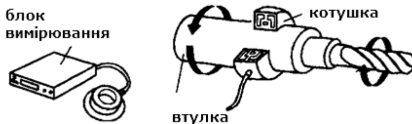
Рис. 1.13. Вимірювач крутного моменту при роботі осьовим інструментом
