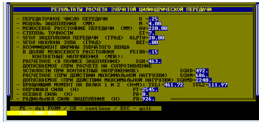
Рис. 2.22. - Результаты розрахунку зубчастої циліндричної передачі
