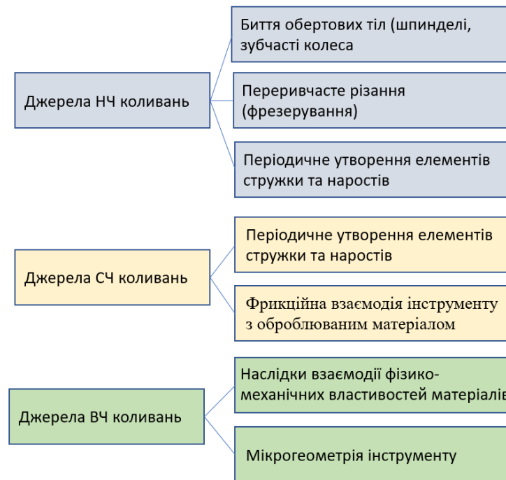
Рис. 1.17. Джерела збудження різного виду коливань на металорізальних верстатах
