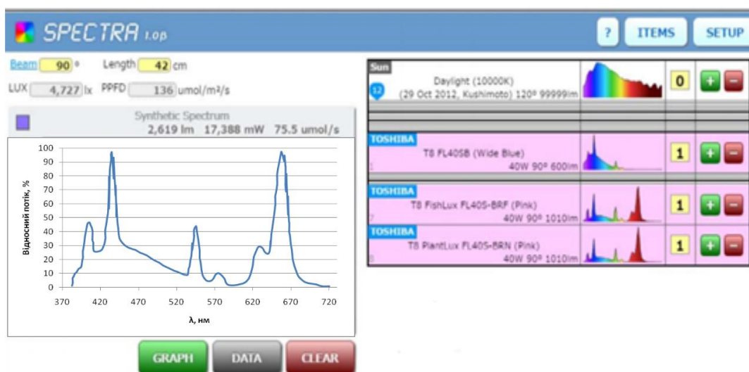
Рисунок 3.9 – Спектральний показник для росту врожаю шпинату з флуоресцентним освітленням
