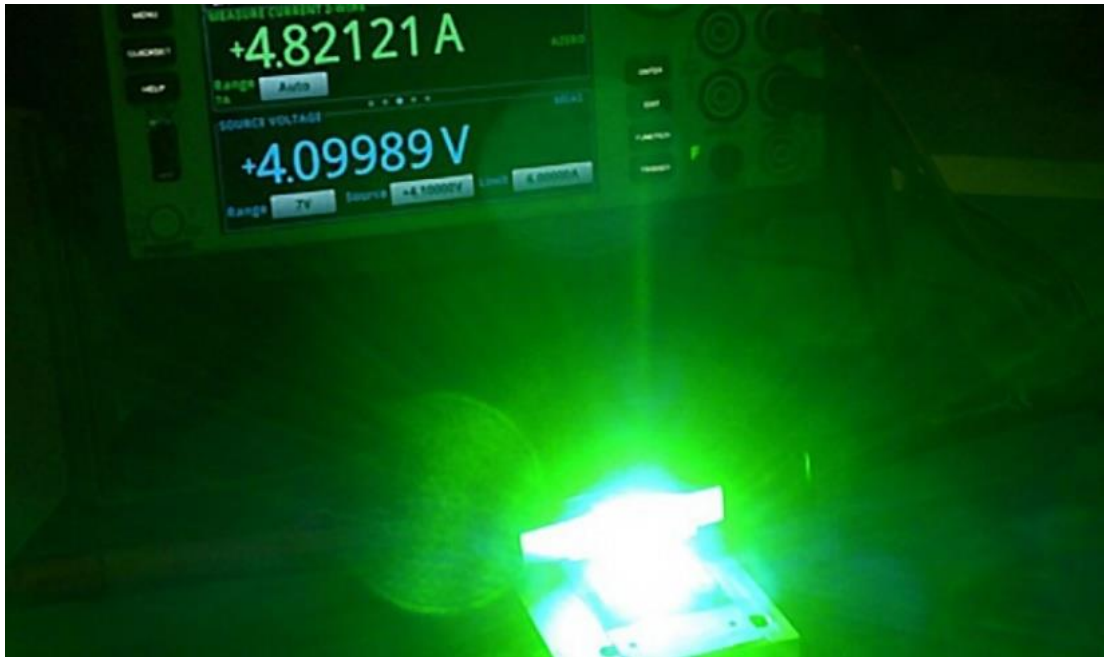
Рисунок 2.9 – HBLED світиться при 4,1 вольт та 4,8 ампера.
